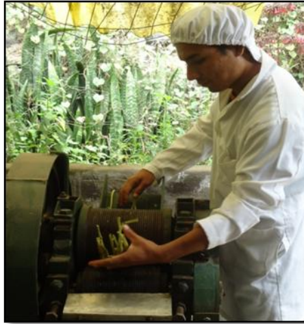
Fotografía 3.13: Prensado en el molino
