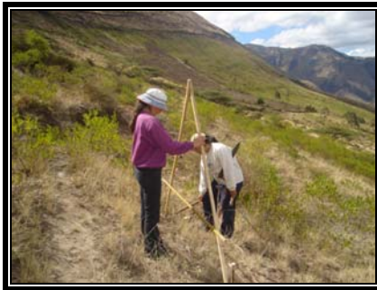
Fotografía 15. Trazado de la curva de nivel en el sitio 4(Aloburo). Yahuarcocha, UTN 2006.
