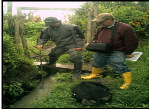
Foto 9 y 10. Medición de Caudales en las Descargas
