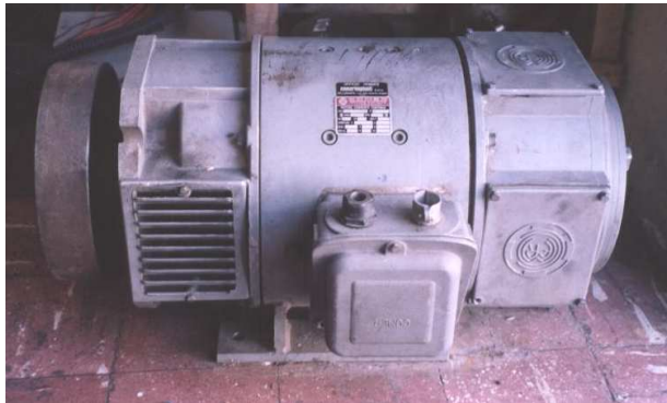
Anexo 13. Reemplazo de motores principales de 50 hp 440 V C.C por 5 hp 220 V C.A.
