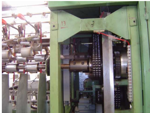
Anexo 10. Electroimanes de Acoplamiento 24 V C.C, para el sistema de movimiento de los cilindros productores y alimentadores
