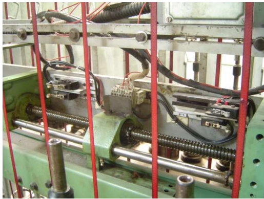
Anexo 2. Tornillo sin fin para el Ascenso y descenso de la bancada.
