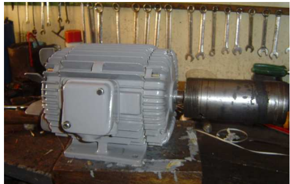
Anexo 13. Reemplazo de motores principales de 50 hp 440 V C.C por 5 hp 220 V C.A.
