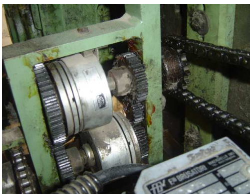
Anexo 11. Electroimanes de Acoplamiento 24 V C.C y motor pequeño para el sistema de subida y bajada de la bancada.
