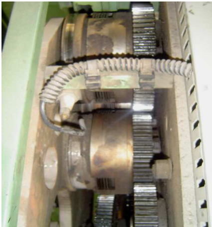
Anexo 10. Electroimanes de Acoplamiento 24 V C.C, para el sistema de movimiento de los cilindros productores y alimentadores
