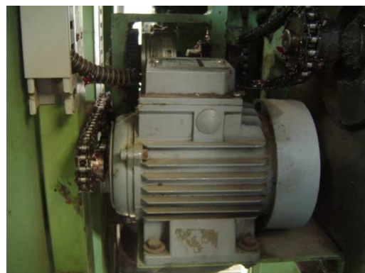
Anexo 11. Electroimanes de Acoplamiento 24 V C.C y motor pequeño para el sistema de subida y bajada de la bancada.
