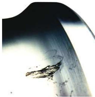
Fig. 68. Falla por fatiga.
