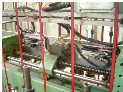
Fig. 78 Tornillo sin fin para el ascenso y descenso de la bancada.
