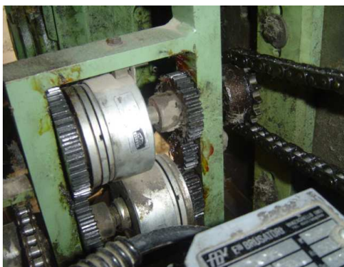
Fig. 85. Electroimanes de Acoplamiento 24 V C.C, para el sistema de subida y Bajada de la bancada
