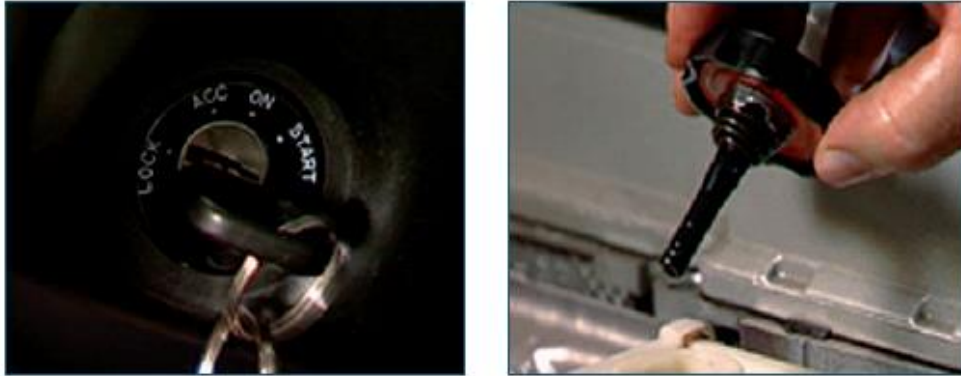
Fig. 52 Verificación del nivel de fluido de la bomba
