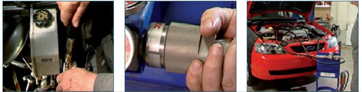
Fig. 51 Conexión del manómetro a la bomba
