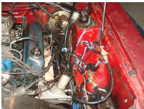
fig. 84 Instalación eléctrica de las electroválvulas
