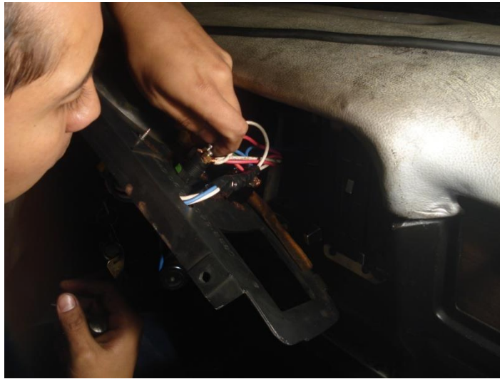
fig. 85 instalación eléctricas del switch de encendido
