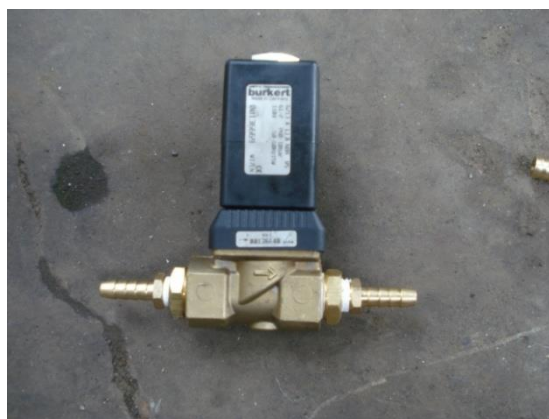
Fig. 78 Válvula sin energía totalmente cerrada
