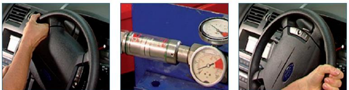
Fig. 55 toma de presión girando el volante a la izquierda
