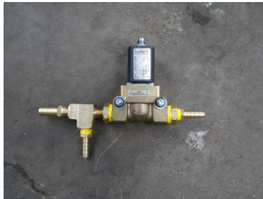
Fig. 77 Válvula sin energía totalmente abierta
