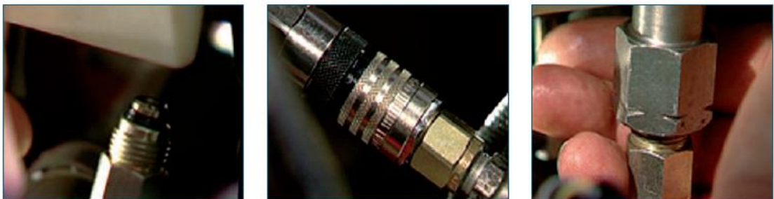
Fig. 50 Manera de conectar el manómetro
