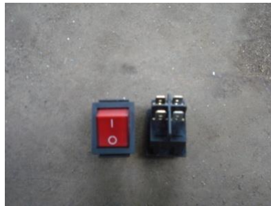
Fig. 63 Interruptor eléctrico de encendido
