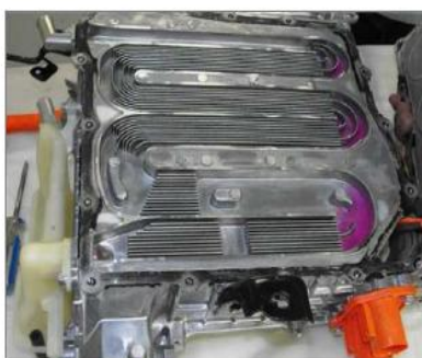
Conductores de refrigeración en el interior del Inversor
