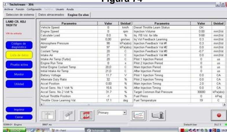
Parámetros de funcionamiento del motor
