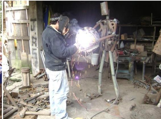
Luego de tener los materiales ya seleccionados para realizar las figuras humanas en chatarra, se utilizó la técnica de la soldadura para armar y así obtener la forma de cada integrante de la banda, este proceso se obtuvo gracias a la utilización de la suelda eléctrica LINCOLN ELECTRIC (110-220), y
