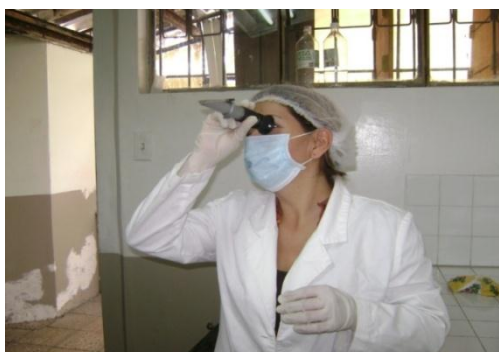
Fotografía 8: Observación en el refractómetro de datos de los sólidos solubles del jugo de borjón. Laboratorio de las Unidades Edu-Productivas. FICAYA-UTN, 8 de octubre de 2010.
