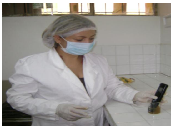
Fotografía 9: Toma de datos del pH del jugo de borojó. Laboratorio de las Unidades Edu-Productivas. FICAYA-UTN, 8 de octubre de 2010.
