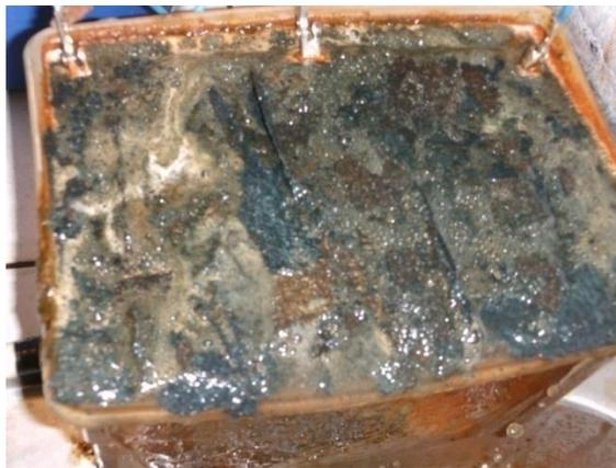
**Foto 11.** Generación de espuma en la electrocoagulación (El Autor).
