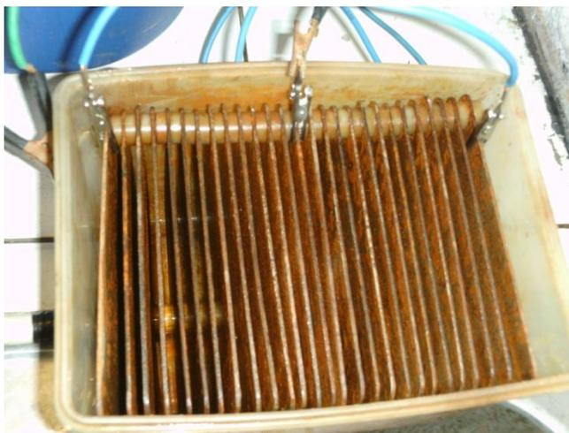
**Foto 2.** Reactor de electrocoagulación. (El Autor)
