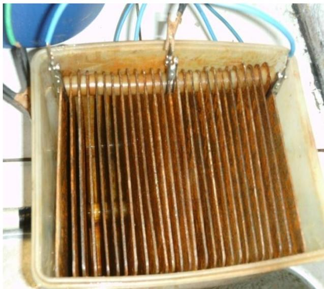
Foto 12. Electrodo con conexión para dos campos. (El Autor)
