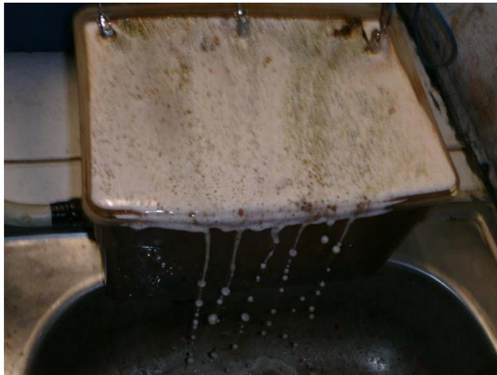
**Foto 10.**El reactor dándose la electrocoagulación. (El Autor)
