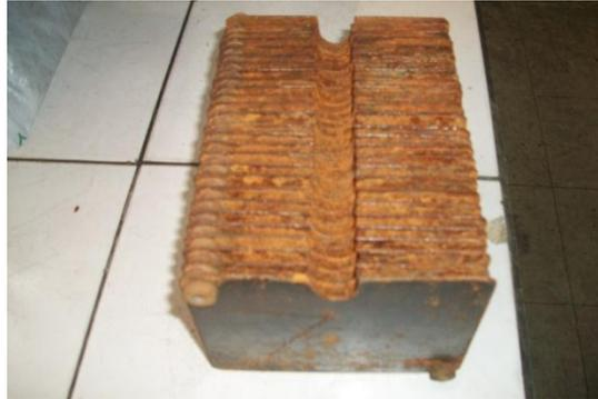
Foto 9. Del sistema de anclaje y separación de electrodos.
