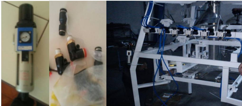
Figura 6.48. Montaje 1 Sistema neumático Fuente: Autores (Gabriela León, Germán Vaca)
