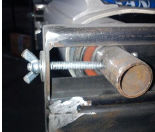
Figura 6.40. Montaje del Sistema de tensión de eje. Fuente: Autor (Gabriela León)
