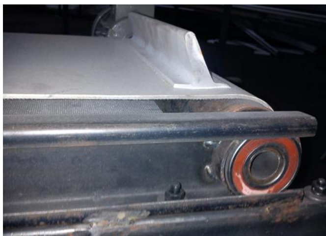
Figura 6.39. Sistema de transporte rodamientos Fuente: Autor (Gabriela León)
