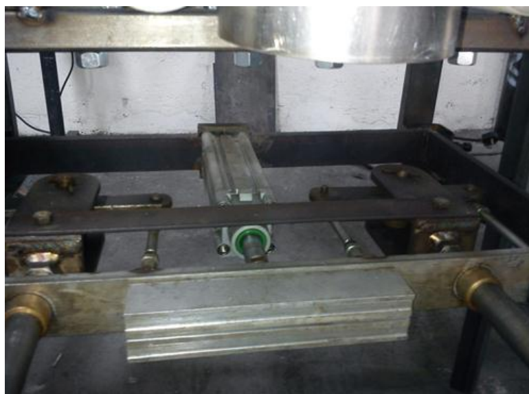
Figura 6.24. Montaje mordazas del Sistema de sellado. Fuente: Autor (Gabriela León)
