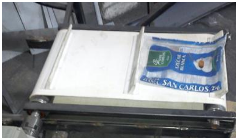
Figura 6.37. Montaje Sistema de transporte 1 Fuente: Autor (Gabriela León)
