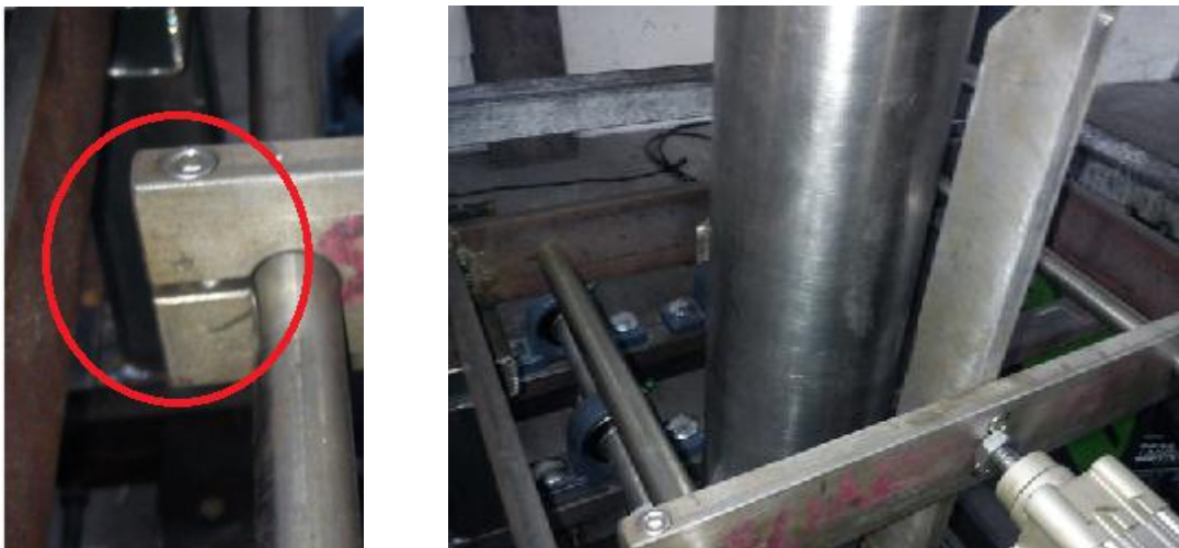
Figura 6.16. Montaje 2 Sistema de sellado vertical. Fuente: Autor (Gabriela León)
