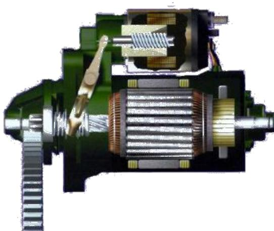
Figura 1.9 Sección del motor de arranque <sup>19</sup>
