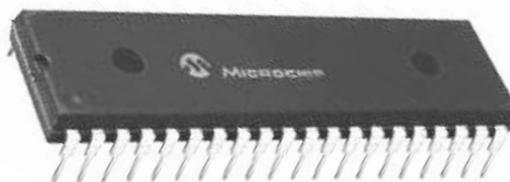
Figura 1.3 Microcontrolador PIC18f4550 de MICROCHIP<sup>7</sup>
