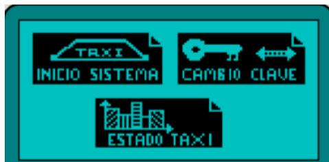
**Inicio del sistema.-** Al presionar en la pantalla sobre esta opción se deberá ingresar una clave de 4 dígitos para acceder al arranque del motor o la visualización de la aplicación como taxímetro. El teclado de ingreso de la clave se verá de la siguiente forma:
