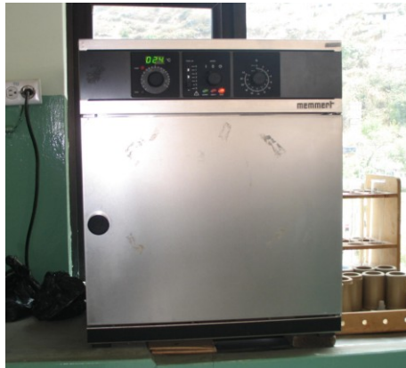
FOTOGRAFÍA 2: Estufa obtención de humedad laboratorios UTN, 2009
