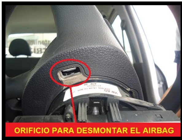
45Figura 4.43. Orificio para desmontar el airbag.
