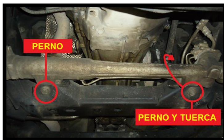
38Figura 4.36. Pernos sujetadores de la caja de dirección.
