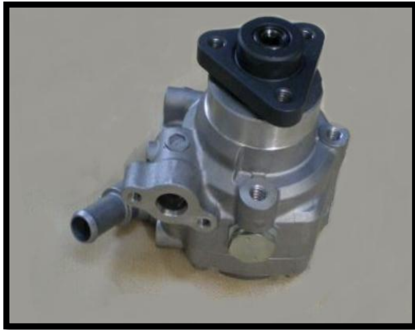
10Figura 4.6. Bomba de la dirección-Amarok.
