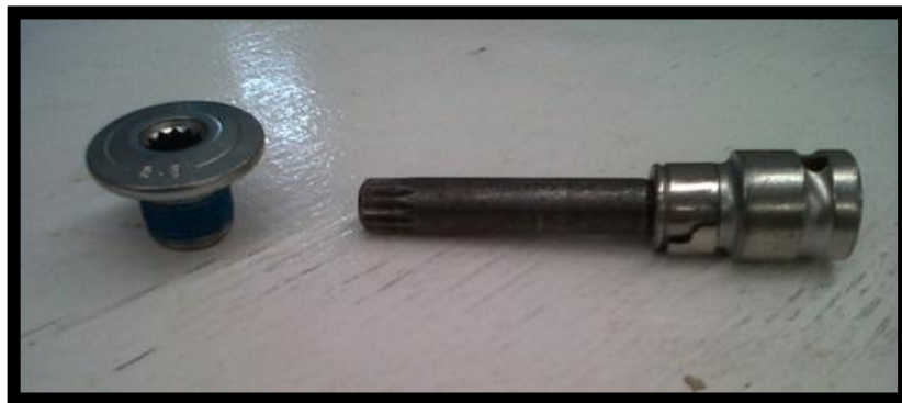
48Figura 4.46. Tuerca y herramienta para desmontar el volante.
