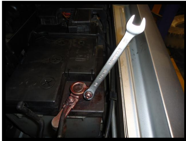
51 Figura 4.49. Desconectar negativo de la batería.
