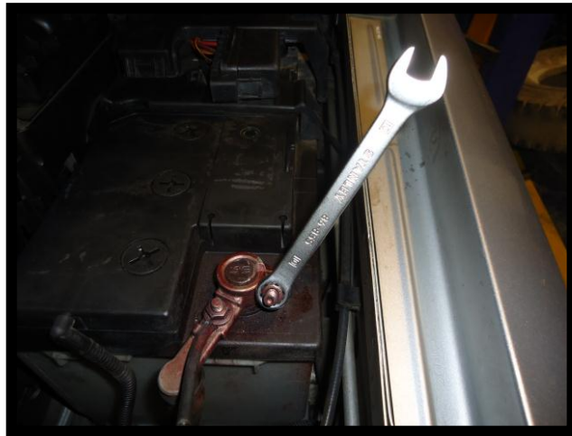
30 Figura 4.28. Desconectar negativo de batería.
