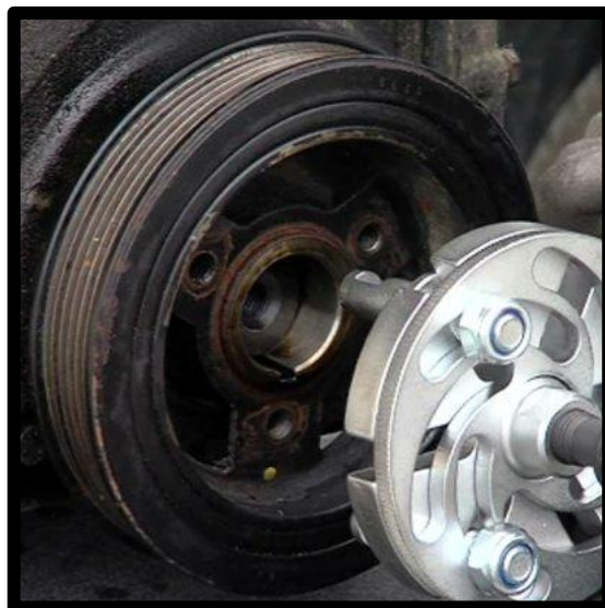
26Figura 4.24. Desmontar polea de la bomba.
