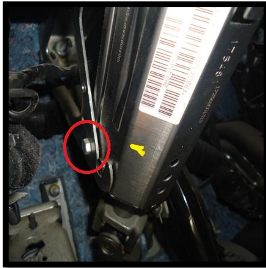
41Figura 4.39. Pernos de la regulación de la columna. Fuente.(Jaramillo & Jativa, 2013).
