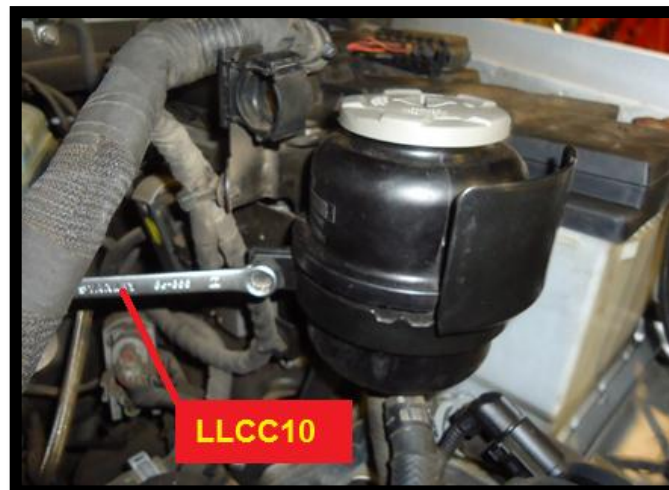
50Figura 4.48. Desmante de la base del depósito.
