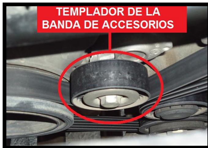
23Figura 4.21. Templador de la banda de accesorios.
