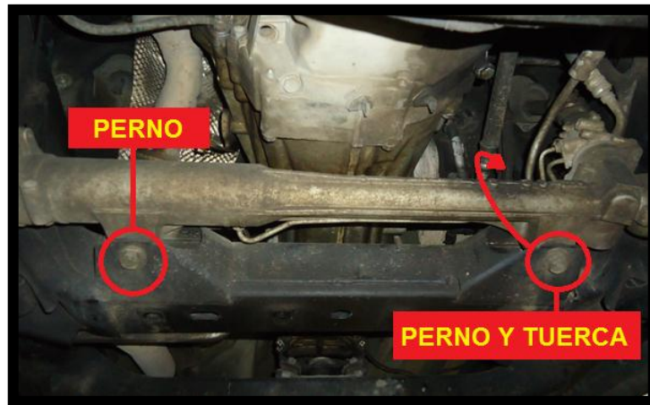
37Figura 4.35. Pernos sujetadores de la caja de dirección.
