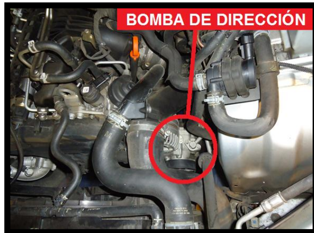
22Figura 4.20. Lugar de la bomba de dirección
