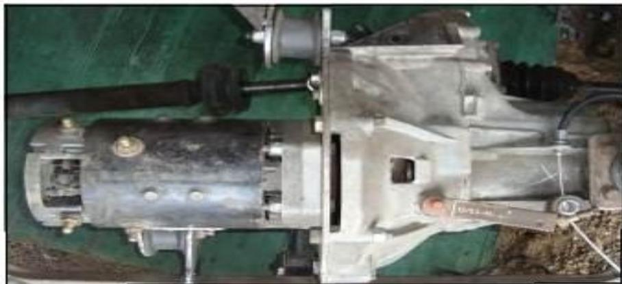
Fig. 24. Motor eléctrico y caja de cambios.
