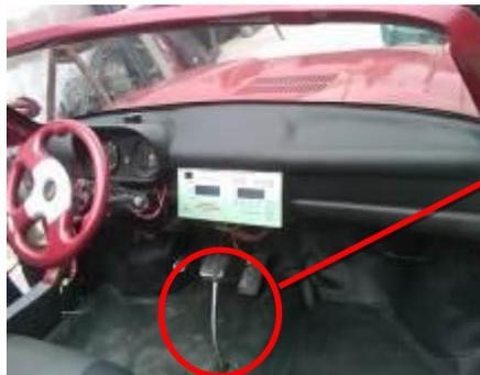
Palanca de la caja de cambios del motor de combustión interna en la posición de neutro.
