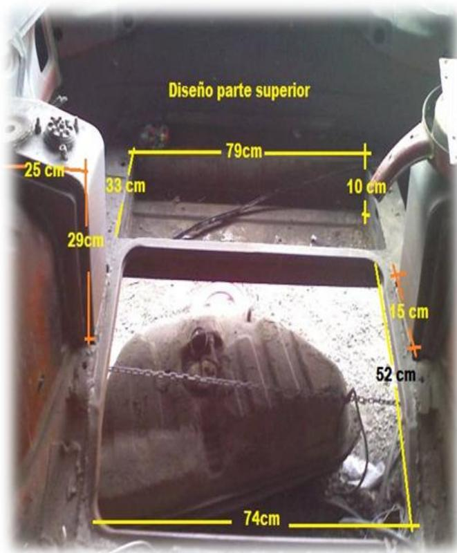
Fig. 30. Corte de la carrocería.
