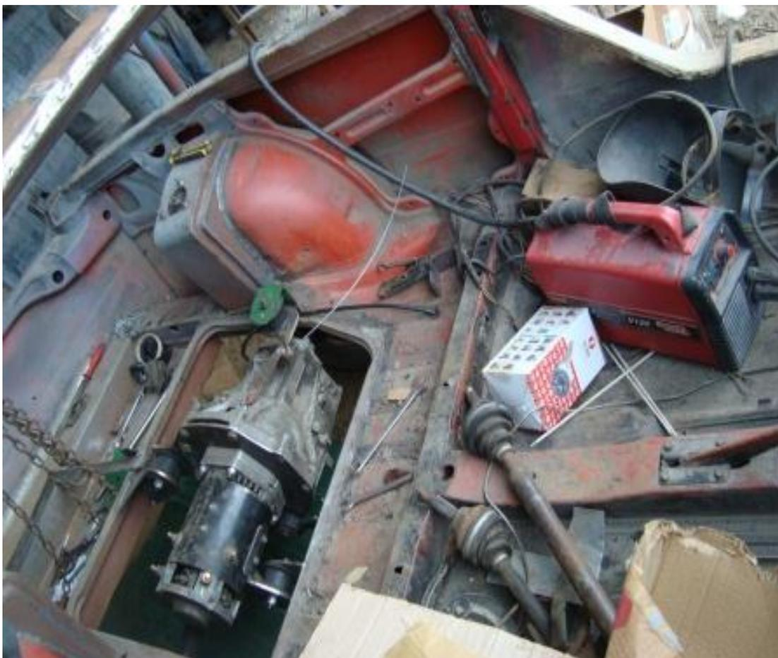
Corte de la carrocería para la instalación del sistema de tracción eléctrico (motor eléctrico y caja de cambios).
