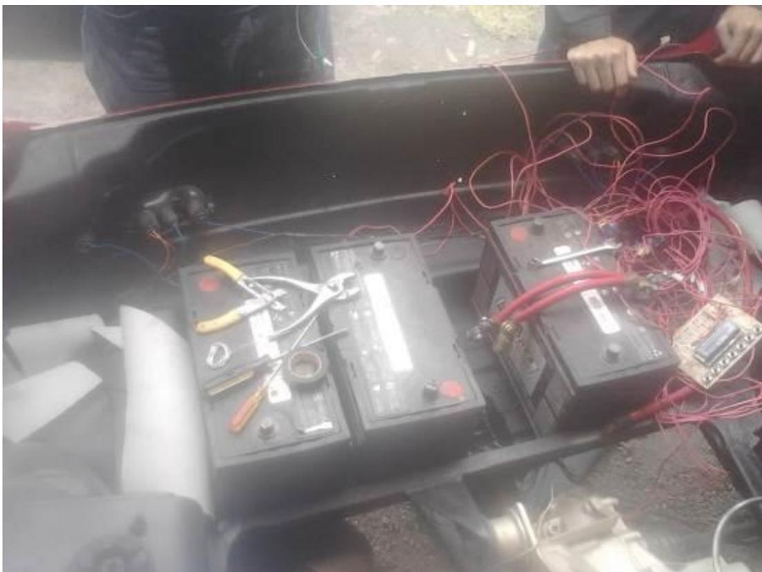
Instalación del sistema eléctrico y electrónico para el dispositivo electromagnético para controlar el cambio de velocidades correspondientes en la caja de cambios.
