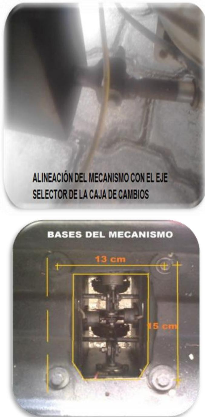
Fig. 37. Alineación del mecanismo.
