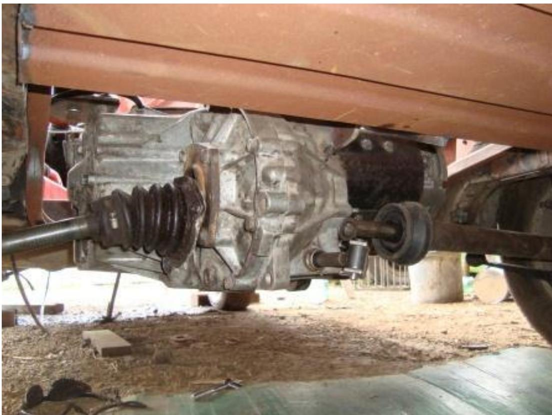
Instalación y alineación del dispositivo mecánico para la selección de las diferentes velocidades de la caja de cambios.
