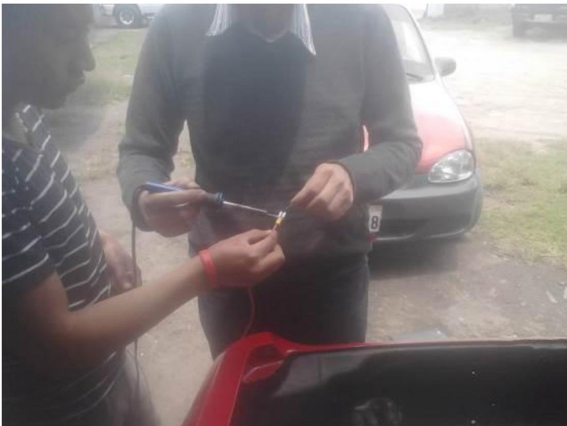
Pruebas de funcionamiento de la tarjeta electrónica de selección de velocidades que va ubicada en el panel del vehículo.
