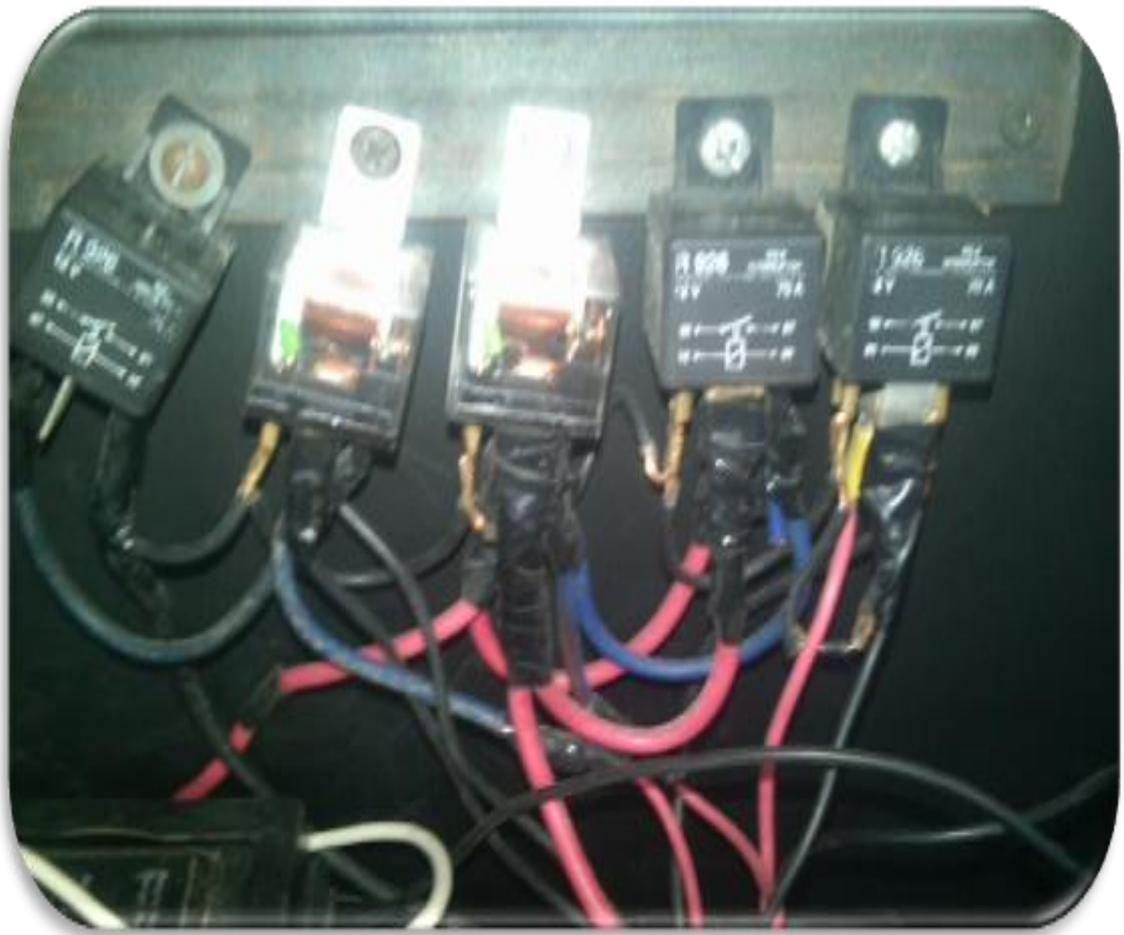
Fig. 17. Relay eléctrico.
