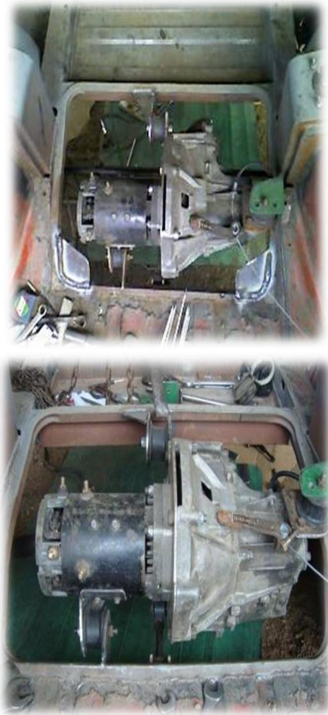
Fig. 32. Instalación del motor y caja de cambios.
