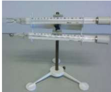
Figura 2. Termómetros de máxima y mínima
