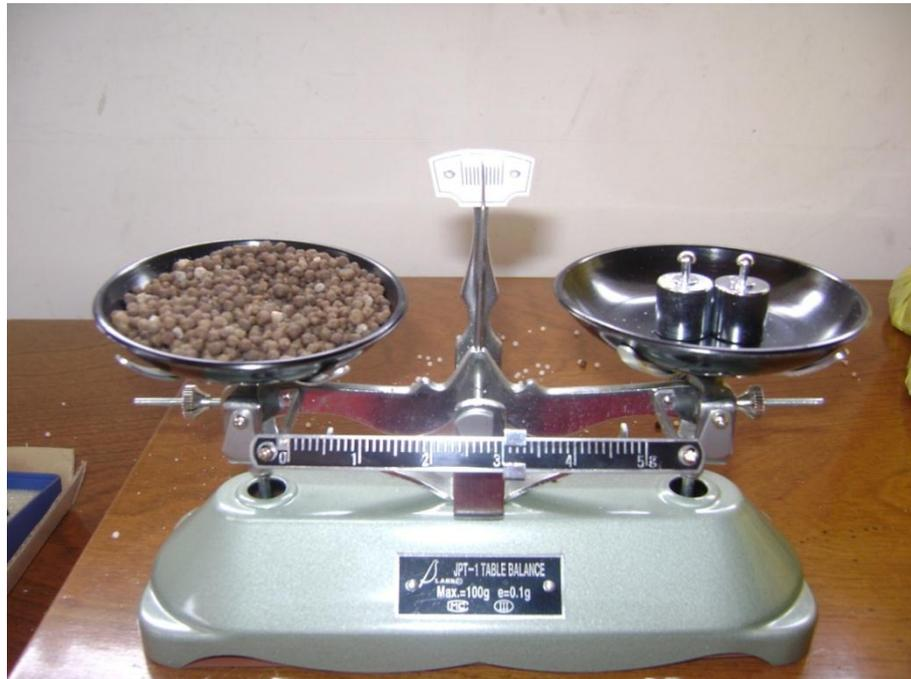
**Fotografía 9.** Pesaje del Fosfato Diamónico
