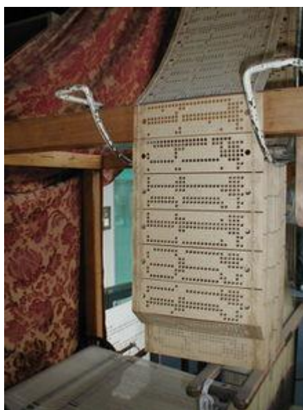
Imagen. 1.27. Tarjetas perforadas en un telar de Jacquard.
