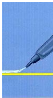
Imagen. 2.32. Recubrimiento por extrusión
