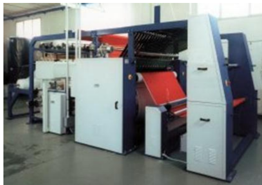
Imagen. 2.31. Vista lateral de laminado con membrana o termofilm
