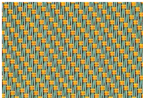
Imagen. 1.25. Estructura de una sarga
