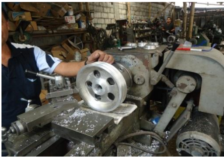
Figura N° 96. Construcción de Polea.
