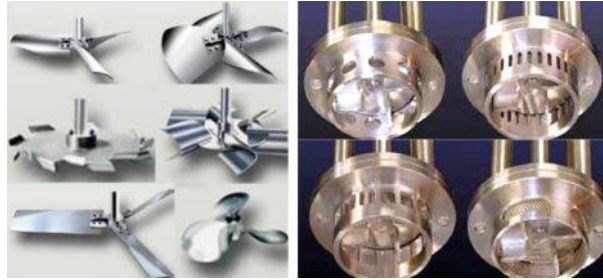
Figura N° 50. Clases de Cabezales con Rotor.
