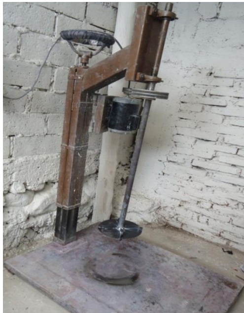
Figura N° 69. Estructura del Mezclador.
