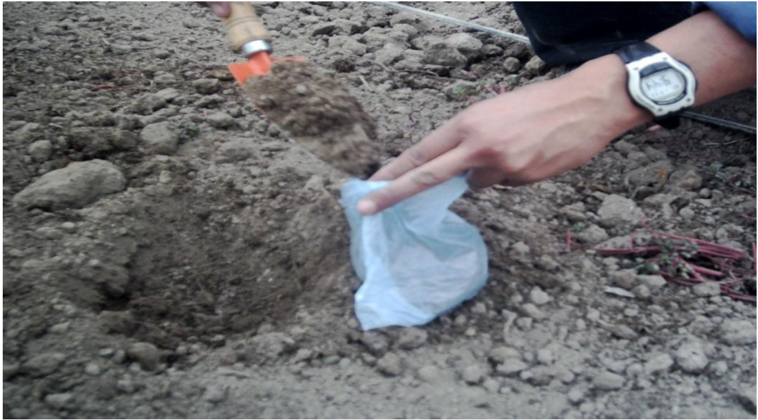
Fotografía 3. Toma de muestras de suelo
