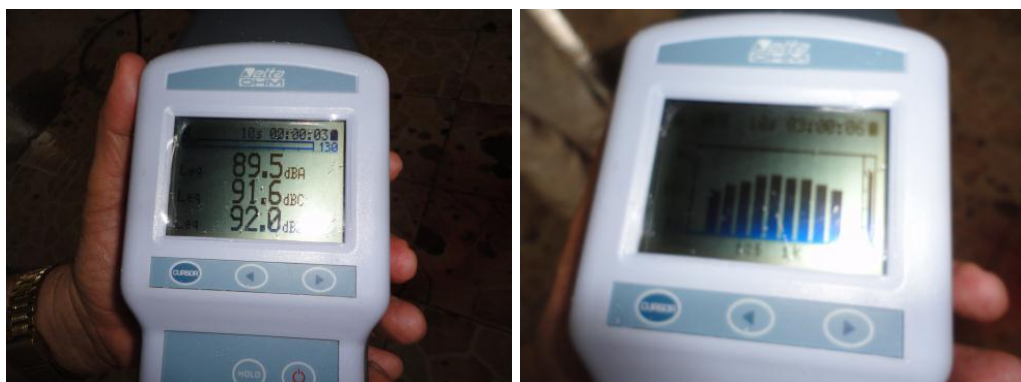
Figura 10.3 Análisis de bandas de octava en la actividad de higiene y desinfección
