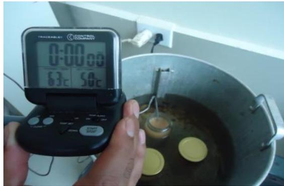
**Fotografía 3.17:** Pasteurización (63 °C x 30 min.)
