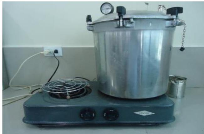
**Fotografía 3.15:** Autoclave (121 °C x 15 min.)
