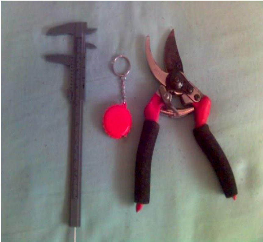
Fotografía 5 Equipo utilizado durante el ensayo (calibrador pie de rey, cinta métrica y tijera de podar).
