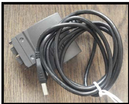
Figura 25: Cable de transmisión de datos
