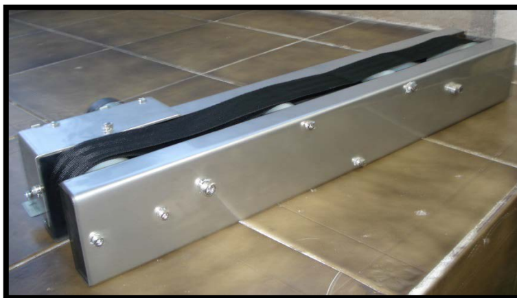
Figura 65: Cinta montada en estructura
