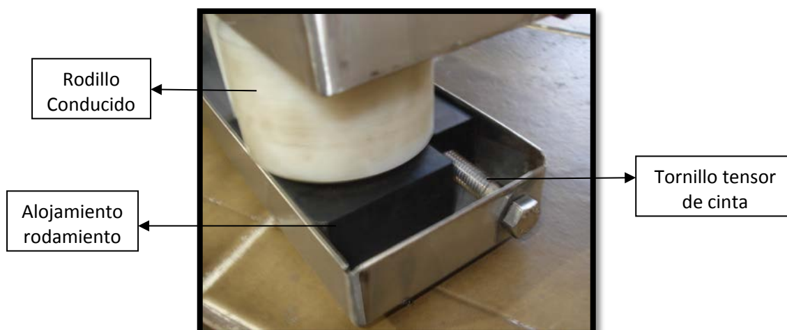
Figura 64: Tensor de cinta Transportadora
