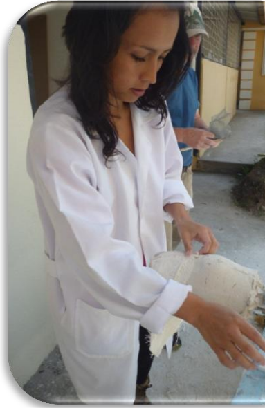
Fotografía 8. Modificación del molde positivo. Parte Final.
