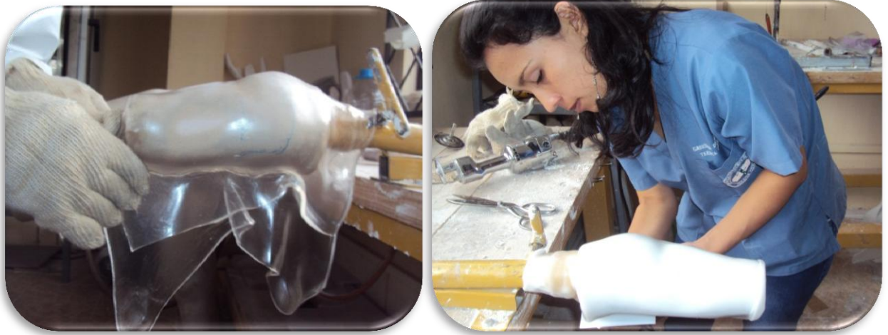
Fotografía 9. Termo conformado del molde positivo
