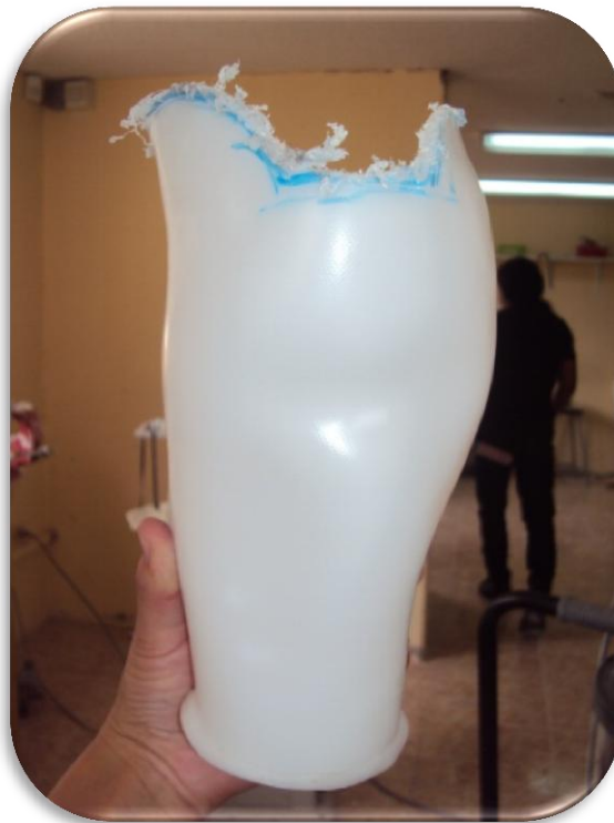
Fotografía 10. Molde positivo desmoldado.
