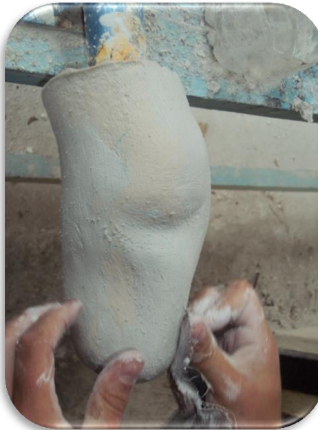
Fotografía 8. Modificación del molde positivo. Parte Final.
