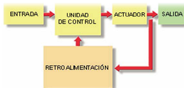
Figura 1.04 – Sistema de Control de lazo cerrado
