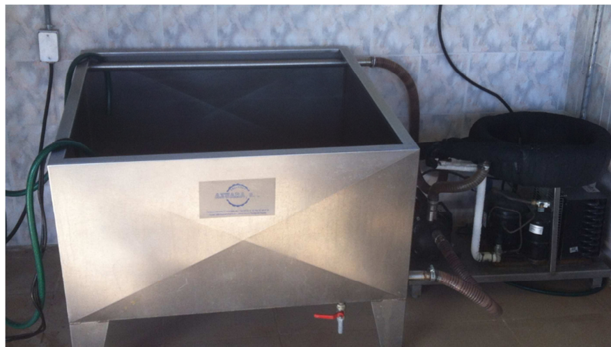
Figura 4.24 – Sistema de enfriamiento del agua
