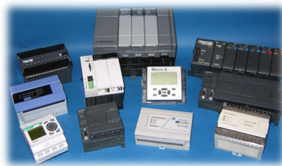
Figura 1.10 – Controladores Lógicos Programables (PLC)
