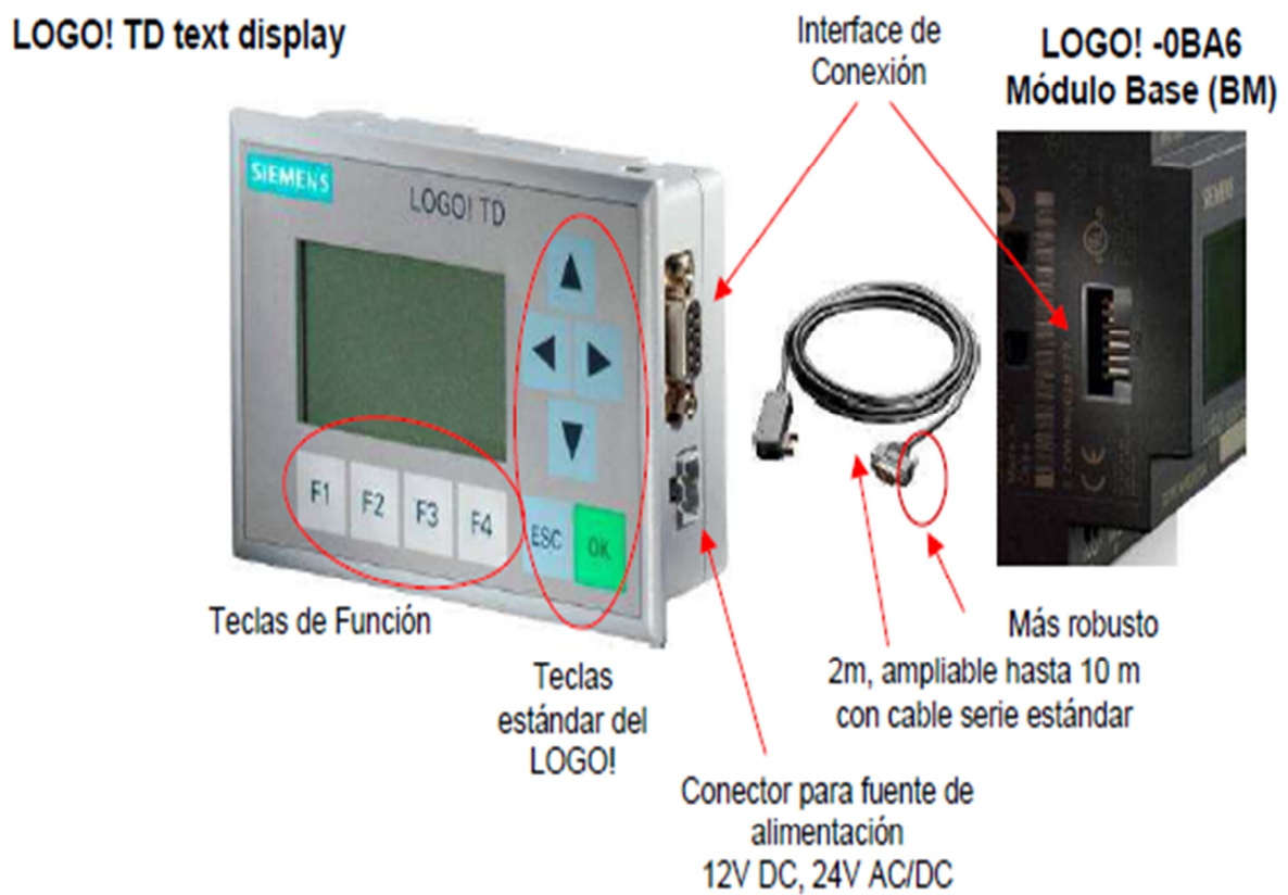
Figura 3.12 – Estructura del HMI LOGO! TD
