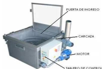
**Figura 6.** Lavador tipo vertical con canastilla giratoria
