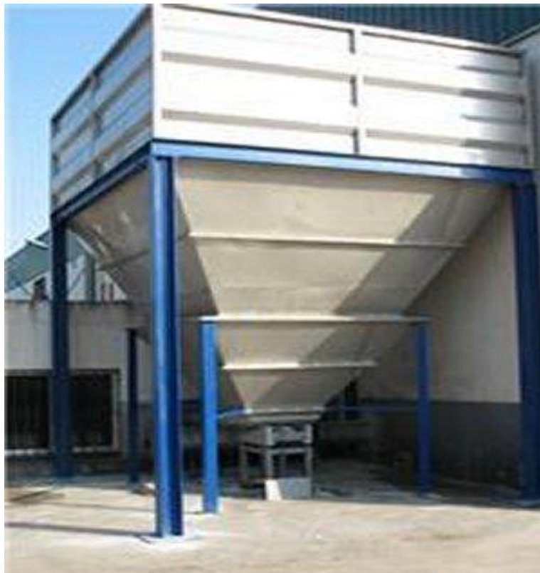
Figura 1.11 Grafico Alternativa 1 (Sistema Almacenamiento de Panela)
