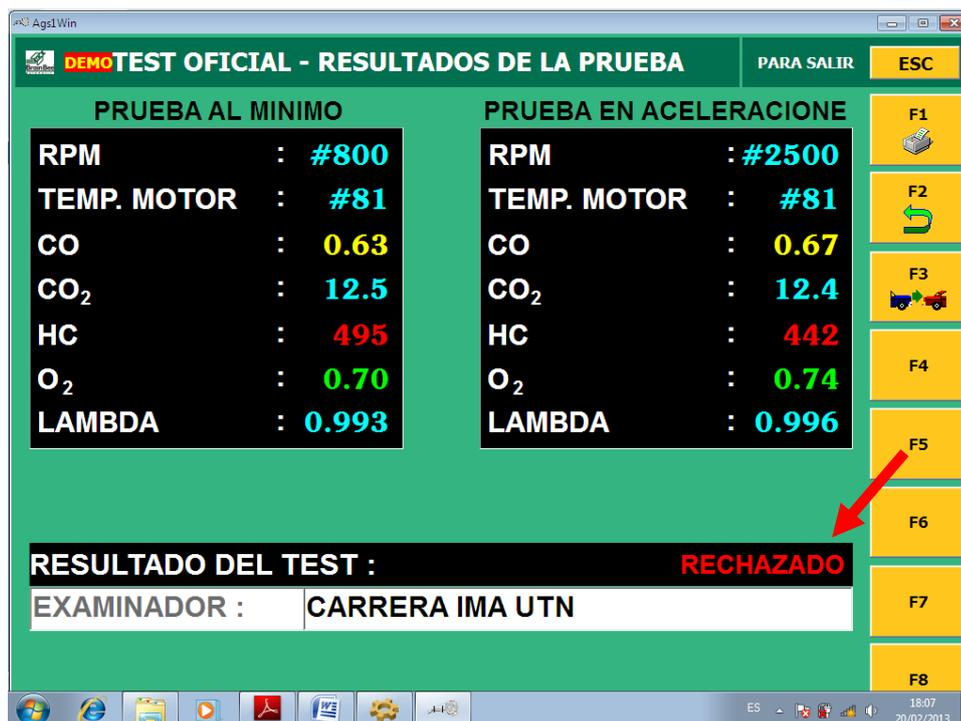
En esta pantalla se detalla los valores de las cantidades de gases que salieron por el escape del vehículo analizado y en la parte inferior de esta, se obtiene el resultado del test oficial valido para el Ecuador.
