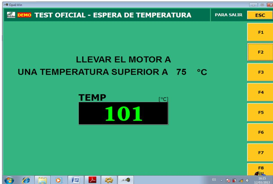
Una vez alcanzada la temperatura de trabajo se observa el siguiente dialogo en la pantalla dice: se debe insertar la sonda dentro del tubo de escape para medir la opacidad; se le click en OK.
