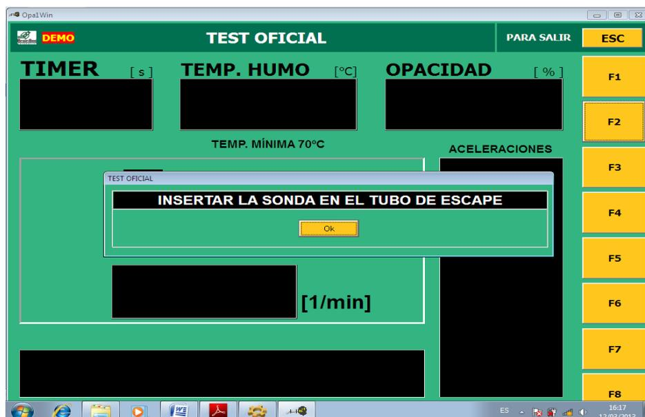
Después el software da el momento en que se debe dar las aceleraciones correspondientes para la toma de valores: cuando esta de color verde la parte inferior de la pantalla, con un texto que dice ACELERACIONE, indica que se debe dar una sola aceleración de 850 a 3000 rpm.
