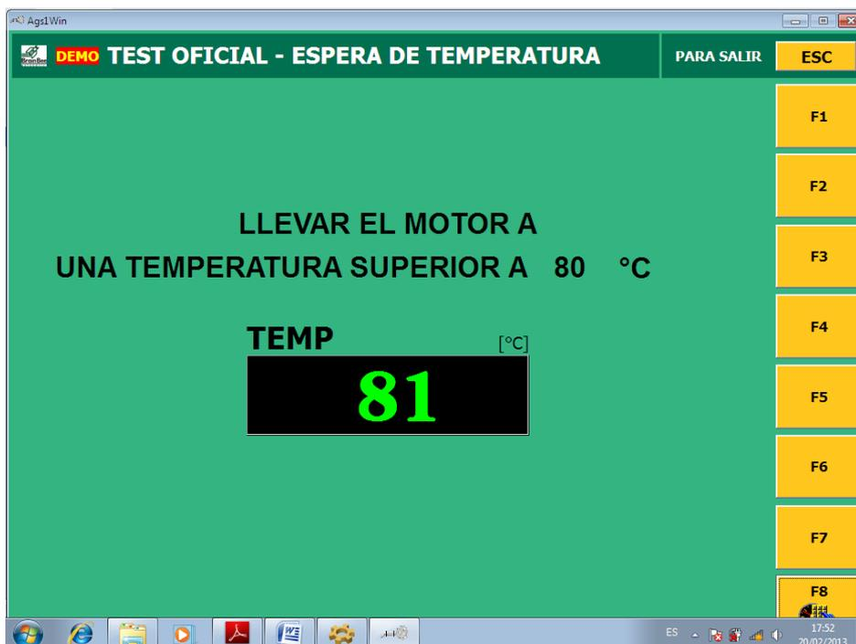
Una vez que el motor alcanzado este rango de temperatura, el cual es le correcto para la lectura de los gases, prosigue al siguiente paso que es el de la prueba de medición de vapores en ralentí; el software se encarga de medir las cantidades. En la pantalla se puede observar los siguientes parámetros de medición. Se señalan los principales que se debe tomar en cuenta para la medida en ralentí:
