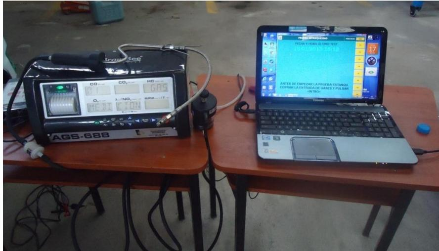
Gráfico 22. Equipo para análisis de 4 Gases mediante una PC
