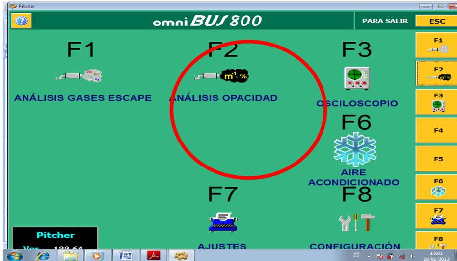
Posteriormente se despliega la siguiente pantalla, que es la del TEST OFICIAL de opacidad válido para Ecuador
