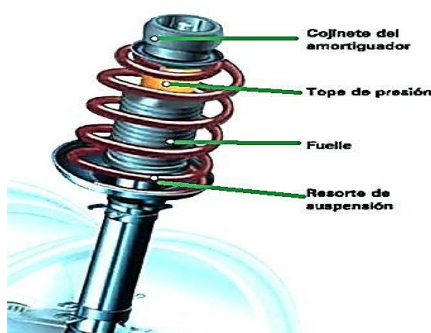
Figura 11. Muelle helicoidal. Fuente. (Meganeboy, Suspensión, 2011).
