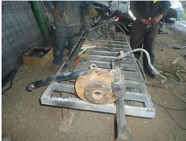
Figura 74. Eje transversal de la parte posterior.
