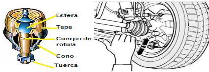
Figura 18. Rotulas de suspensión. Fuente. (Meganeboy, Suspensión, 2011).
