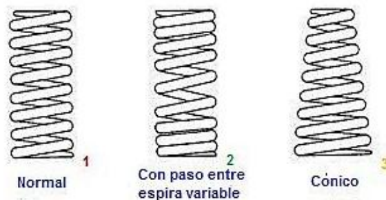
Figura13. Tipos de muelles. Fuente. (Meganeboy, Suspensión, 2011).
