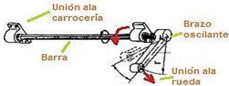
Figura 14. Barra de torsión. Fuente. (Meganeboy, Suspensión, 2011).
