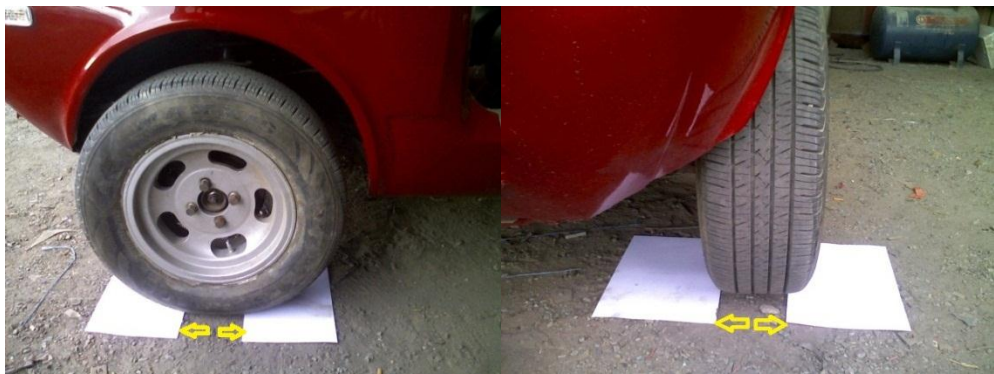
Figura 55. Posición del vehículo para toma de medidas de peso.
