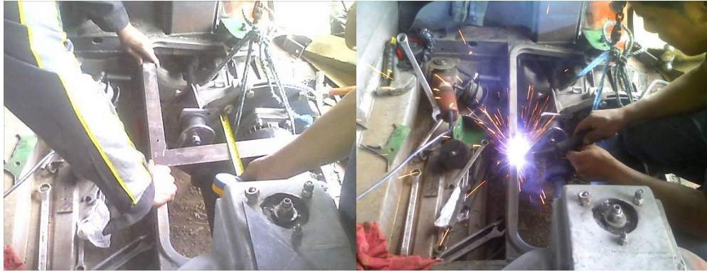
Figura 61. Colocación de bases de acople motor-caja con la carrocería.
