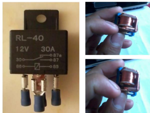
Figura 4.27. Relé de 12V. Fuente. Autores.
