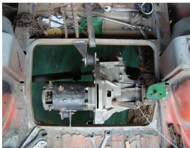
Figura 4.11. Montaje del motor. Fuente. Autores.
