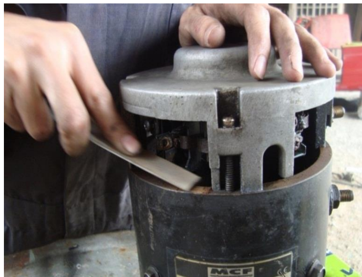
Figura 4.5. Limpieza externa motor C.C. Fuente. Autores.
