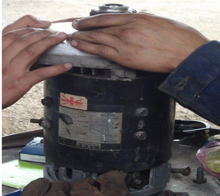
Figura 4.4. Limpieza externa motor C.C. Fuente. Autores.
