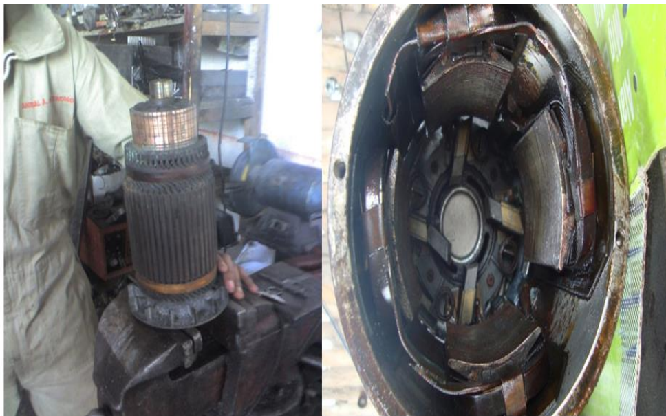
Figura 4.7. Sustitución de carbones. Fuente. Autores.
