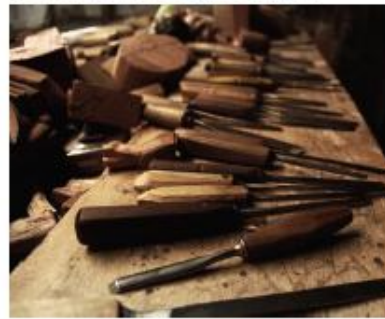
TALLER. Los instrumentos con los que se talla la madera.
