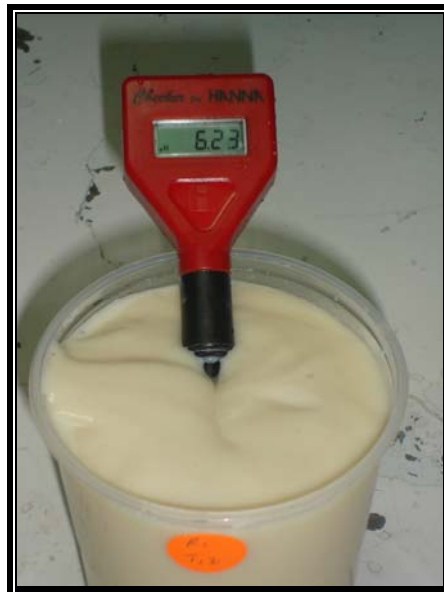
Fotografía 6: Medición de pH
