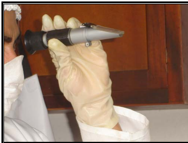
Fotografía 5: Medición de grados Brix
