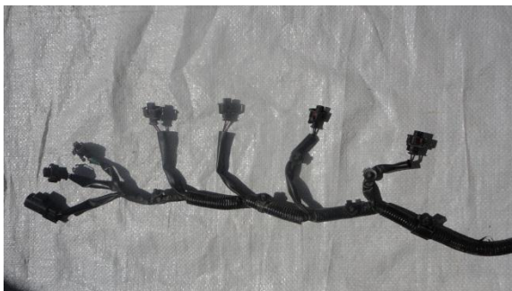
Socket de Enlace de la ECM y el Relé Principal
