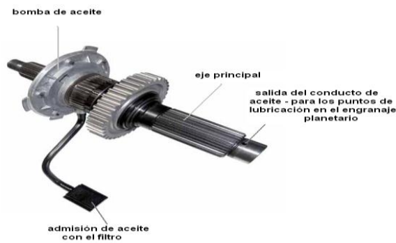
Figura N° 77. Partes del sistema de Lubricación.
