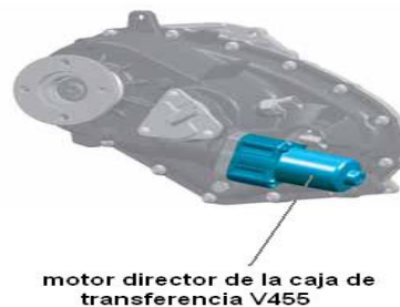
Figura N° 79. Caja de transferencia J646.
