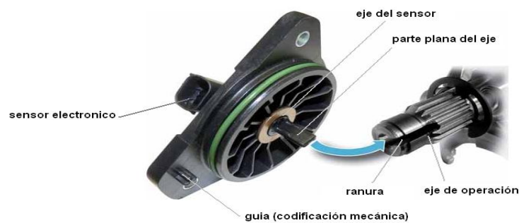
Figura N° 84. Partes del sensor hall para la caja de transferencia G759
