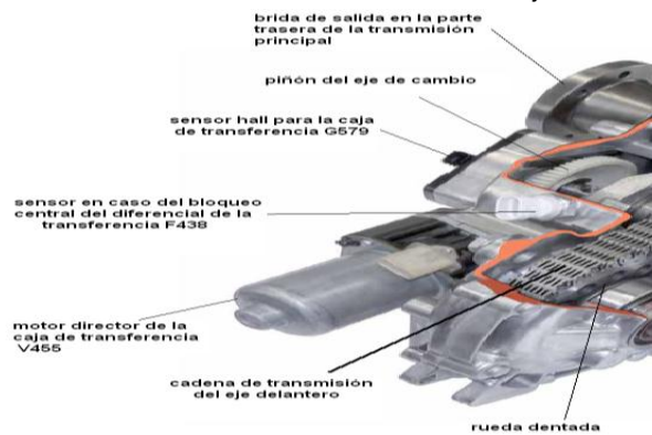
Figura N° 65. Caja de transferencia con accionamiento del eje delantero plug-0C7 parte 1
