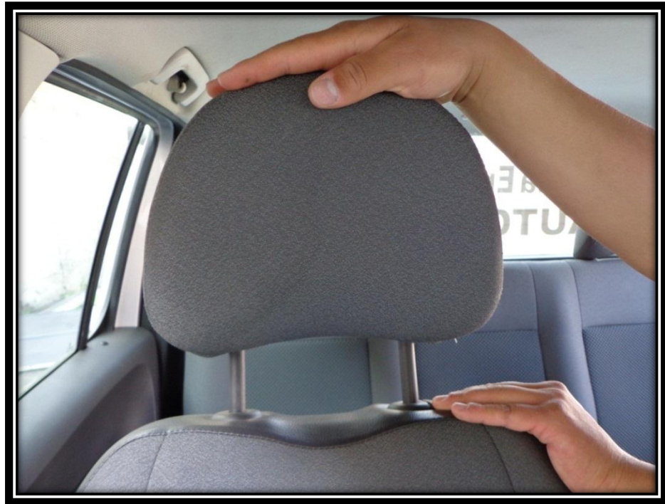
Figura 121: Montaje de los apoya cabezas del asiento de la camioneta Amarok
