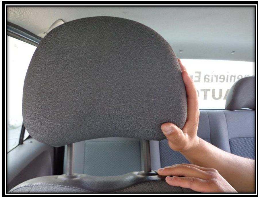
Figura 120: Desmontaje de los apoya cabezas del asiento de la camioneta Amarok
