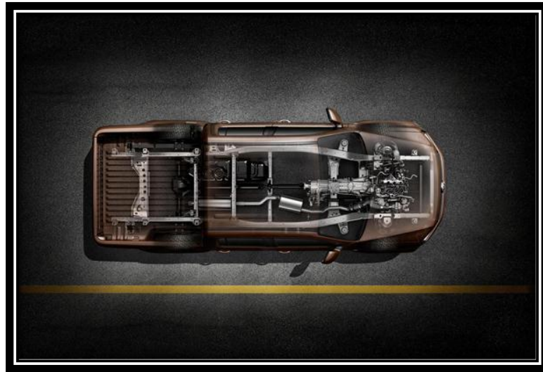
Figura 55: Vista longitudinal del chasis de la Amarok
