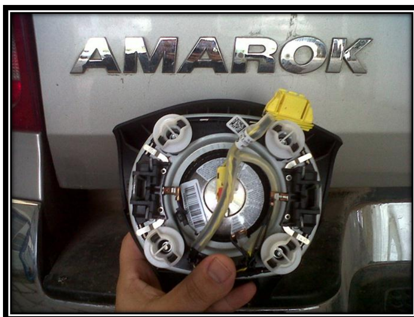
Figura 37: Bobina de accionamiento del sistema Airbag de la camioneta Volkswagen Amarok
