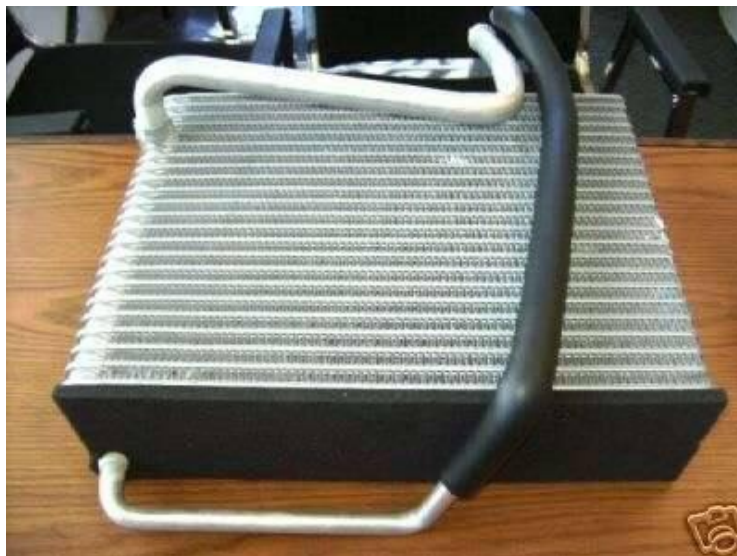
Figura 7: Evaporador del sistema de aire acondicionado del vehículo
