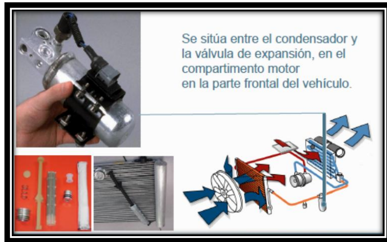
Figura 85: Filtro deshidratante del Aire Acondicionado
