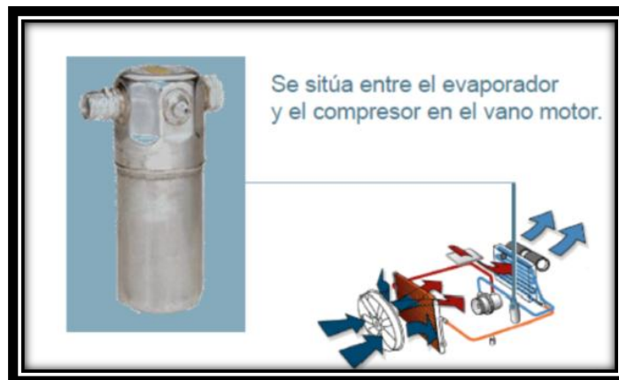
Figura 90: Acumulador del sistema de Climatización del vehículo
