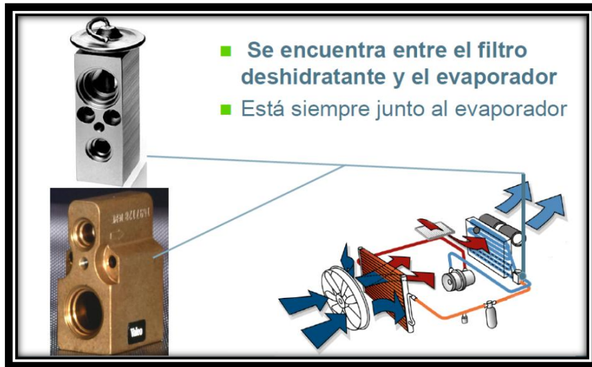
Figura 87: Válvula de Expansión del Aire Acondicionado
