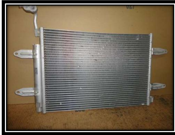
Figura 80: Condensador del sistema “Climatic” de la camioneta Amarok Fuente: (S.A., Condensador de aire acondicionado vw Saveiro 2 011, 2 011)
