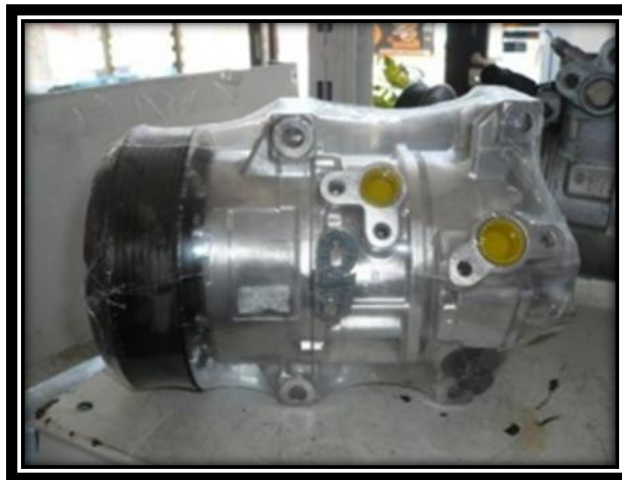
Figura 75: Compresor del sistema “Climatic” de la camioneta Amarok
