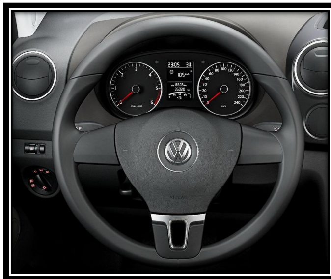
Figura 46: Localización del Airbag del conductor de la camioneta Volkswagen Amarok
