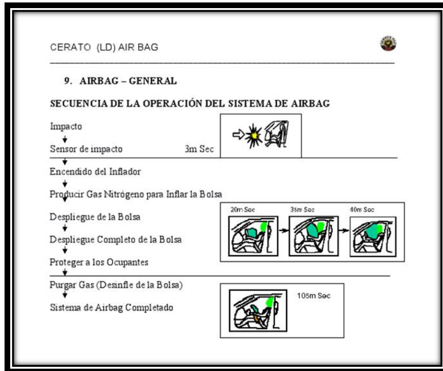
Figura 24: Secuencia de Operación del Sistema Airbag
