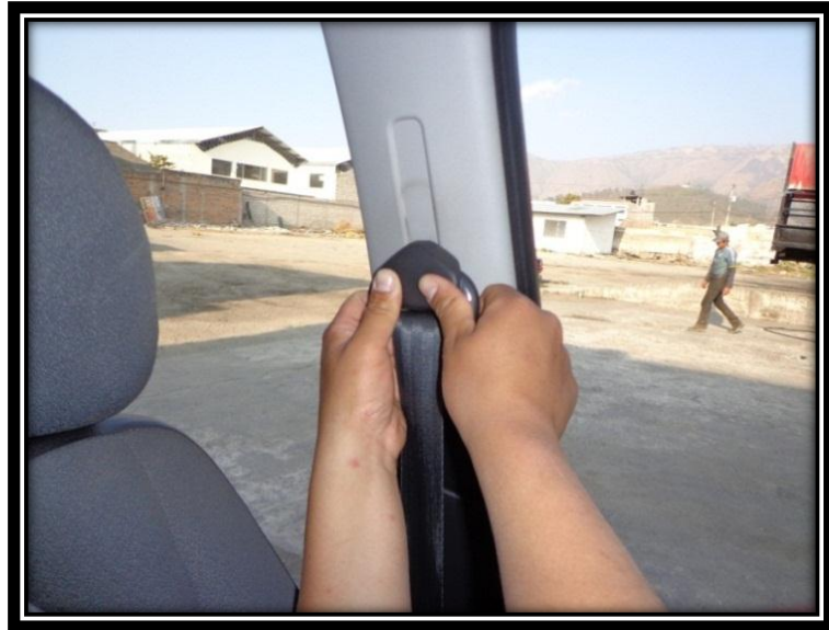
Figura 52: Regulador de la altura del cinturón de seguridad de la camioneta Amarok
