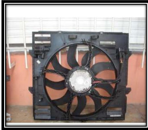
Figura 81: Electroventilador del sistema “Climatic” de la camioneta Amarok
