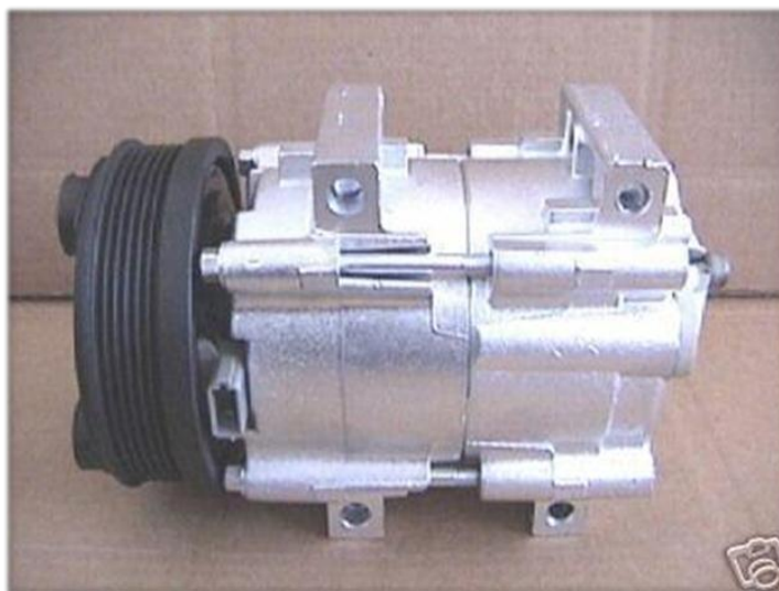
Figura 5: Compresor del sistema de aire acondicionado del vehículo
