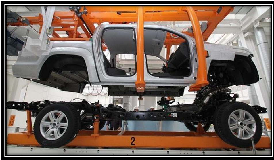
Figura 58: Carrocería y Chasis de la Amarok
