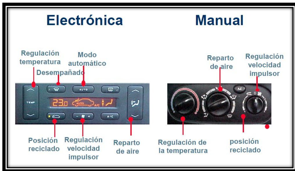
Figura 100: Mandos de control del sistema de Aire Acondicionado
