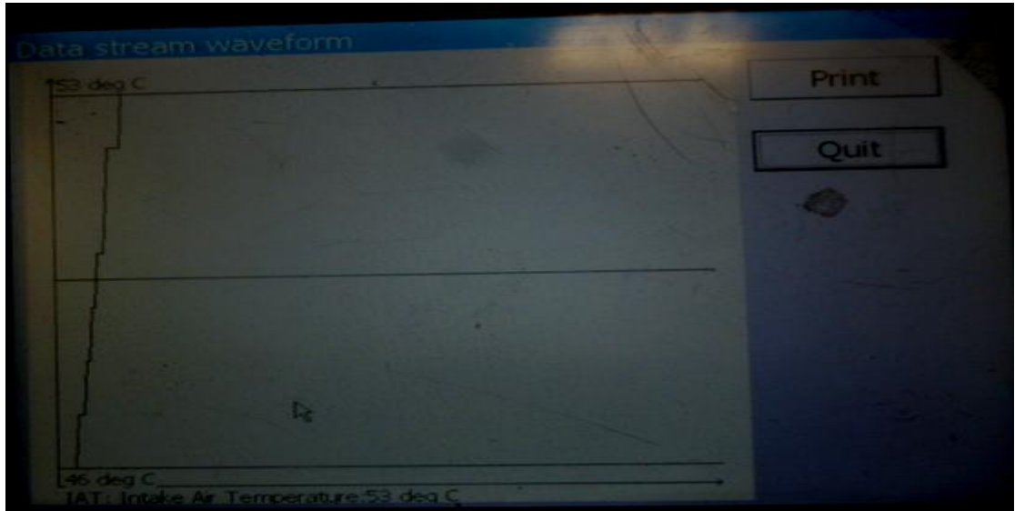
Gráfico 10. Formas de Onda del Sensor IAT.
