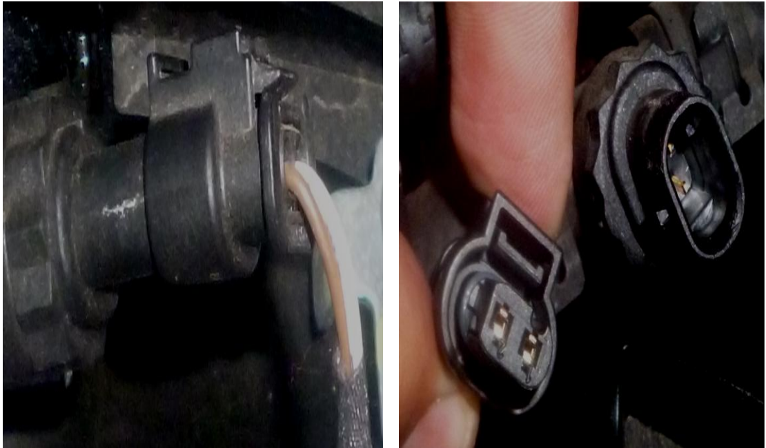
Figura 13. Cables de Conexión del Sensor de Temperatura de Combustible.
