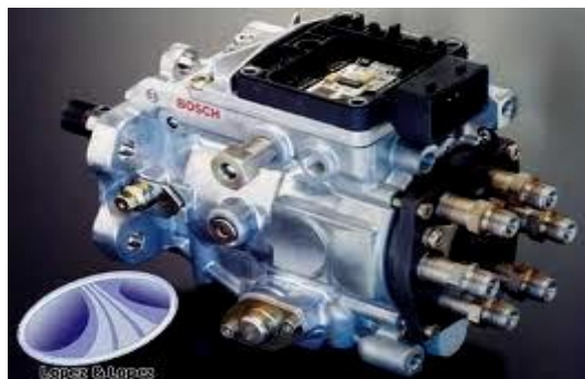
Figura 2. Bomba diesel Bosch incorporada la ECU.
