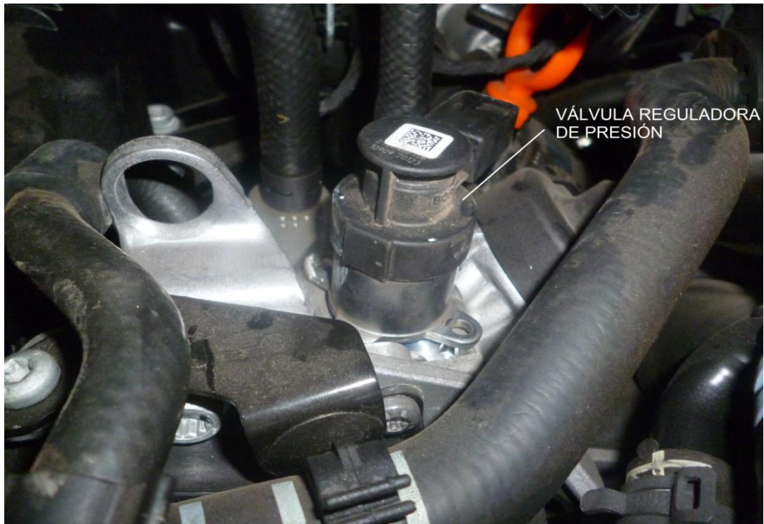
Figura 9. Ubicación de la Válvula Reguladora de Presión.
