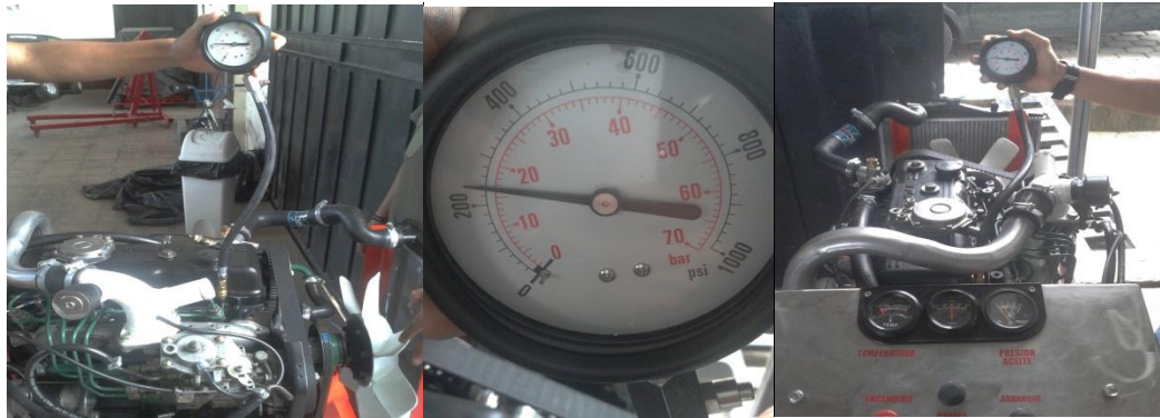
Figura 182. Medida de la presión de compresión.
