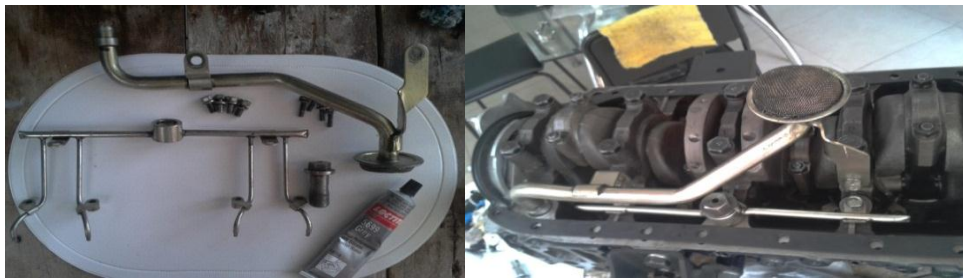
Figura 144. Colador y tuberías de lubricación a chorro.
