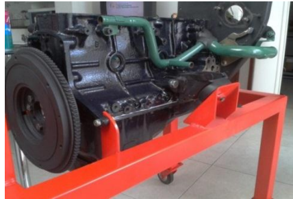
Figura 151. Tubería inferior derecha de refrigeración.
