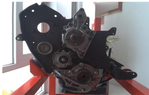
Figura 149. Bomba de agua instalada. Fuente. (Almeida & Puma, Figuras y tablas, 2012).
