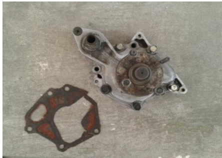
Figura 71. Bomba de agua.
