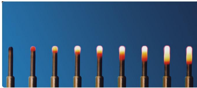
Figura 44. Proceso de calentamiento de una bujía.
