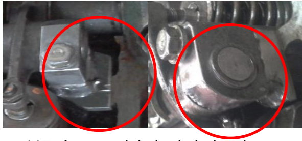
Figura 117. Apoyos del eje de balancines nuevos. Fuente. (Almeida & Puma, Figuras y tablas, 2012).
