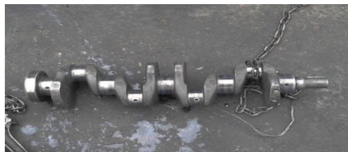
Figura 86. Lavado del cigüeñal.
