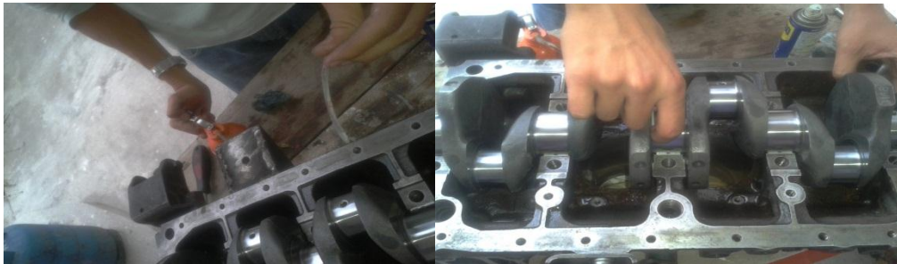
Figura 135. Montaje del cigüeñal.
