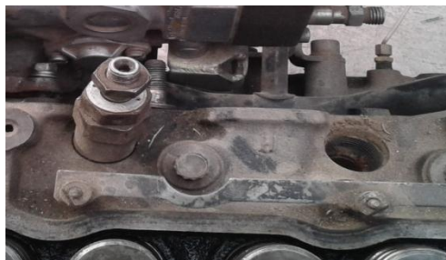
Figura 65. Inyectores, bujías de pre calentamiento.
