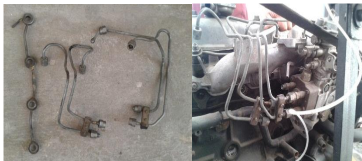
Figura 63. Tuberías de inyección y retorno.
