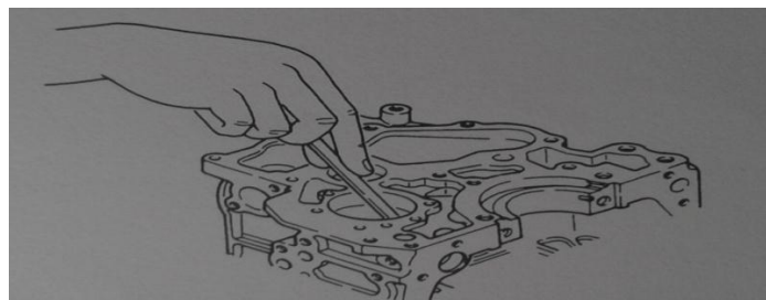
Figura 125. Medición de holgura entre la cara del rotor exterior y el bloque de cilindros.
