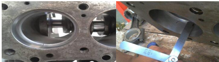
Figura 122. Holgura entre puntas de los segmentos.
