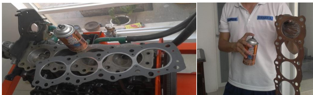
Figura 155. Preparación del empaque o junta de la culata. Fuente. (Almeida & Puma, Fotos, 2012).
