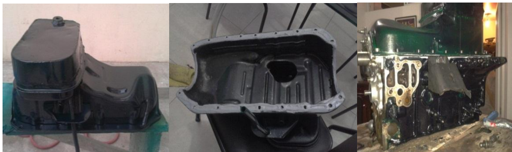
Figura 146. Colocación del cárter.
