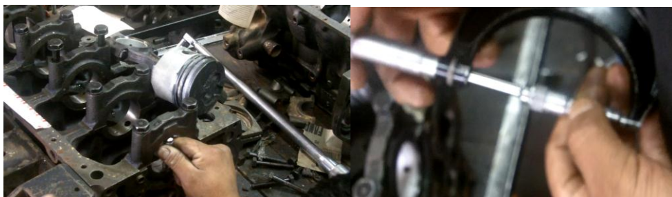
Figura 89. Medición de diámetro interno de cojinetes.
