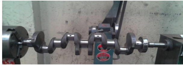
Figura 92. Pulido de cigüeñal.
