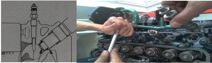
Figura 159. Montaje y ajuste de inyectores.
