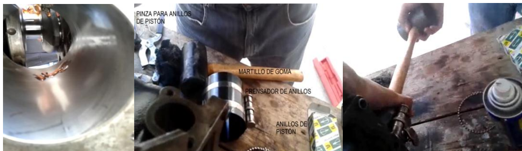
Figura 140. Montaje conjunto biela-pistón.
