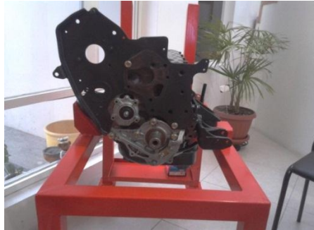
Figura 148. Cubierta frontal del bloque de cilindros instalada. Fuente. (Almeida & Puma, Fotos, 2012).
