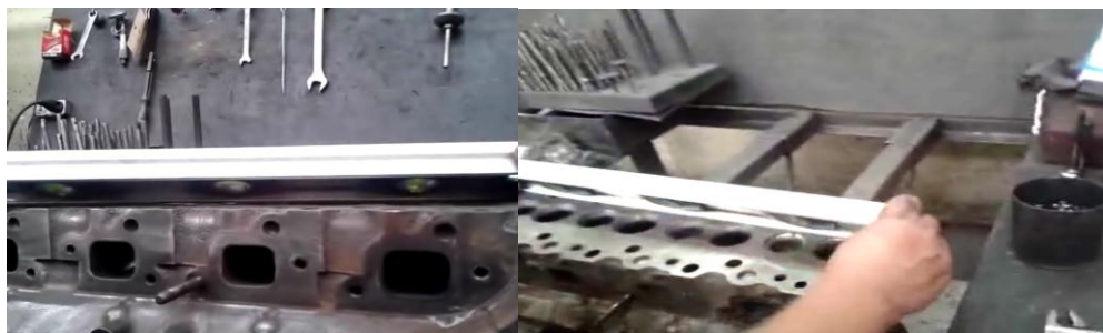
Figura 97. Distorsión cara inferior de la culata
