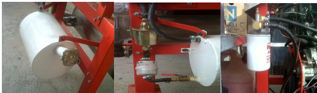
Figura 174. Instalación del depósito de combustible.
