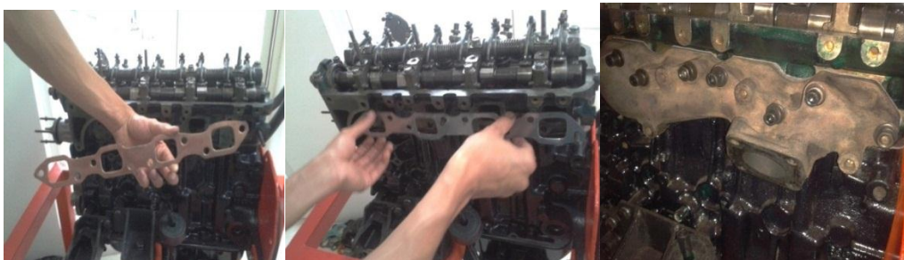
Figura 160. Montaje de juntas o empaques de colectores.
