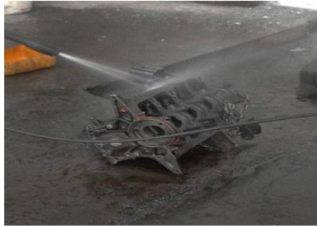
Figura 82. Lavado del bloque de cilindros.
