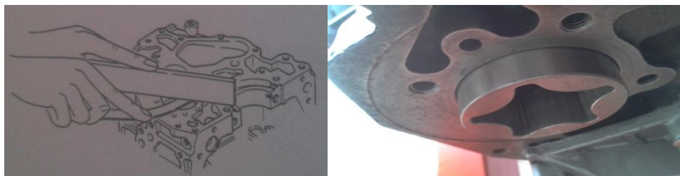
Figura 124. Medición de la holgura entre el bloque de cilindros y rotor exterior.
