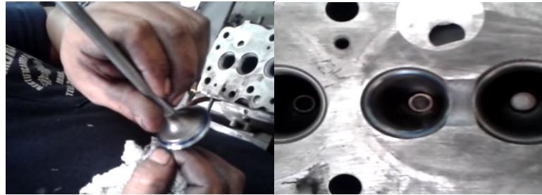
Figura 109. Azul de Prusia marca en el asiento de la válvula.
