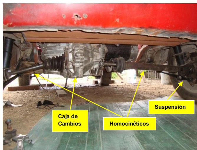
Figura 6.67. Montaje de la tracción delantera en la parte posterior del vehículo- vista frontal.
