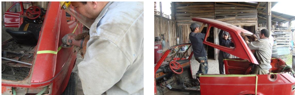
Figuras 6.6.78. Corte de la carrocería.
