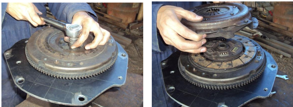
Figuras 6.6.93. Ajuste del embrague al conjunto.
