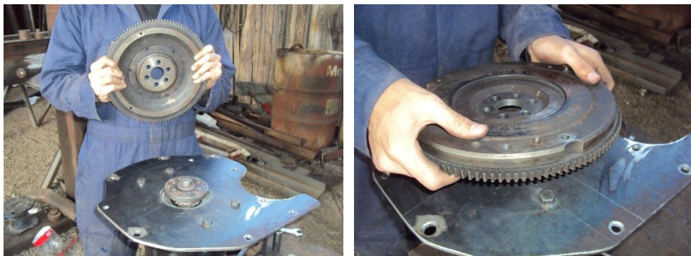
Figuras 6.6.92. Acople del volante del embrague al conjunto.
