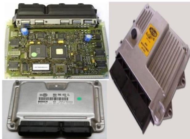
Figura. 30 UCE (Unidad de Control Electrónico)
