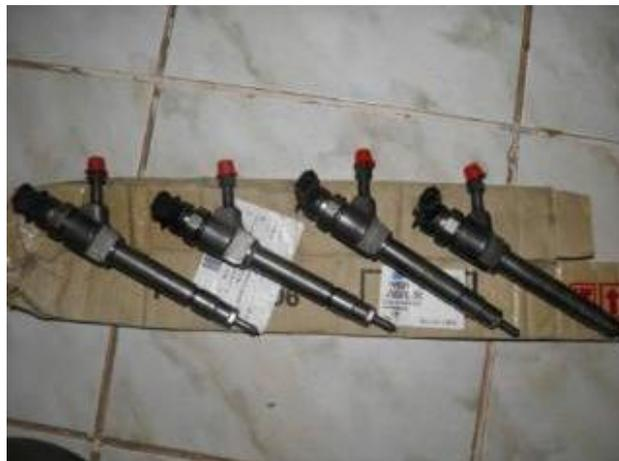
Figura. 56 Inyectores Common Rail
