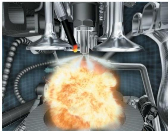
Figura. 36 Inyección dentro del Cilindro
