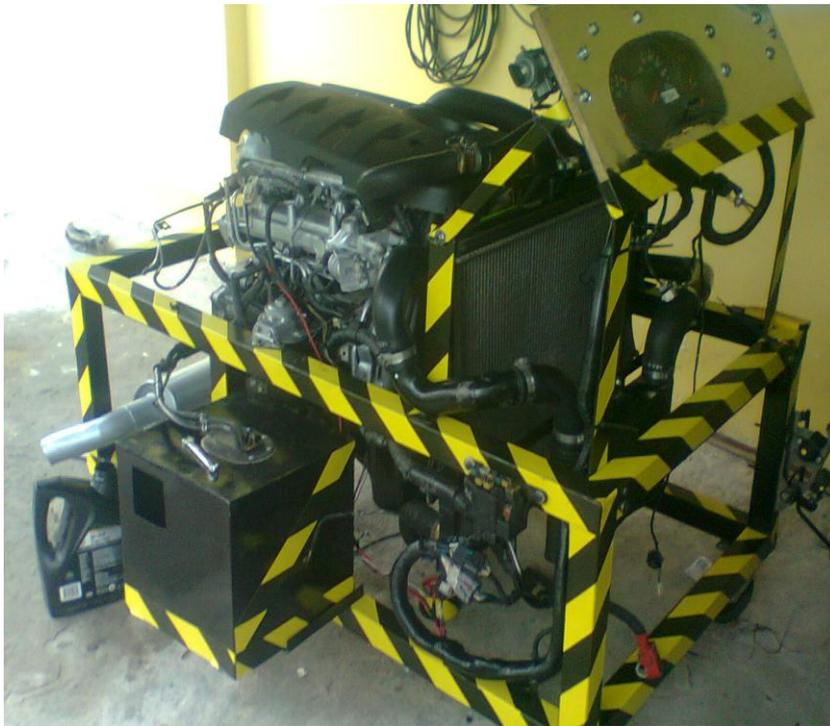
Figura. 26 Maqueta del Motor Mazda BT 50 Diesel
