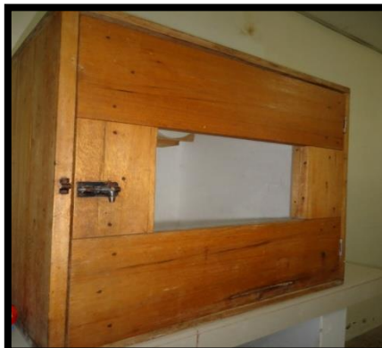
Fotografía 6. Caja de fermentación para yogur
