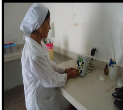
Fotografía 1. Análisis de densidad, grasa, temperatura y sólidos de la leche
