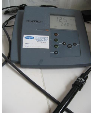
Fotografía 9.3: Medición de conductividad y TDS en las muestras (junio, 2012)
