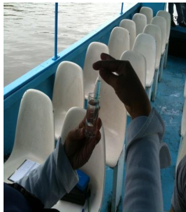
Fotografía 18.3: Medición de Oxígeno Disuelto en la Laguna de Yahuarcocha (mayo, 2012)
