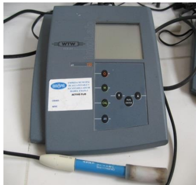
Fotografía 8.3: Medición de pH en las muestras (junio, 2012)
