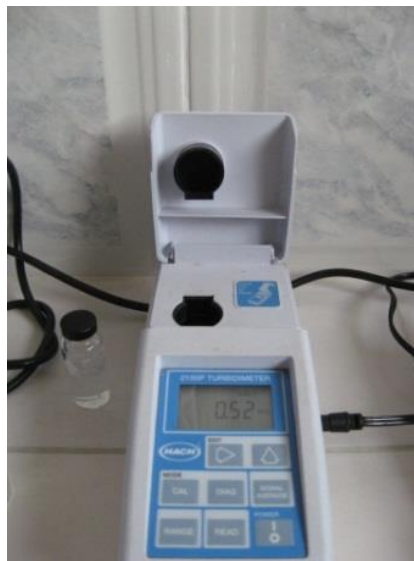
Fotografía 10.3: Medición de turbidez en las muestras (junio, 2012)
