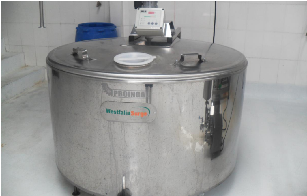
TINA DE ENFRIAMIENTO
