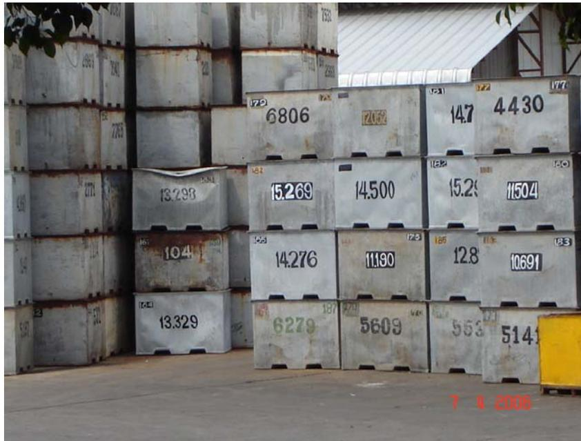
**Foto # 29.** Scows en mal estado en espera de ser reciclados. Se puede apreciar la identificación con un número en el medio y la tara en Kg en una de las esquinas superiores.
