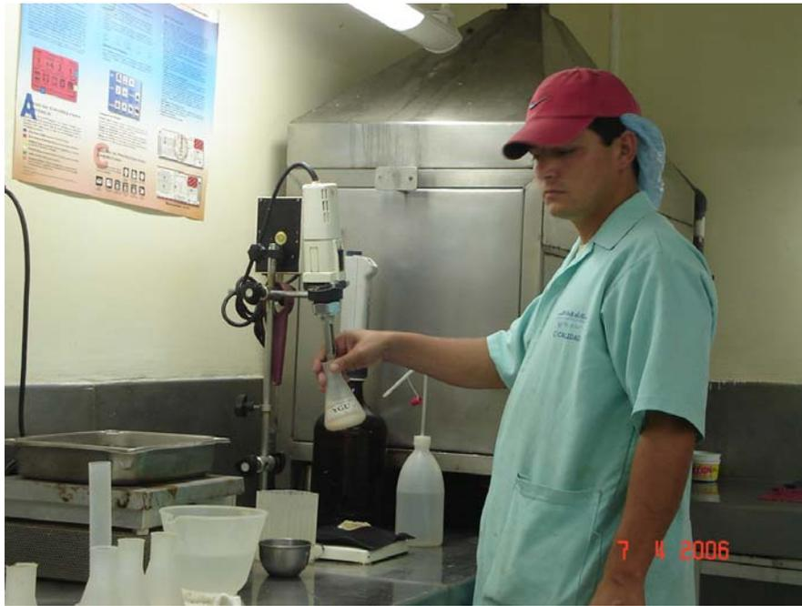
**Foto # 25.** Homogenizado de la muestra.
