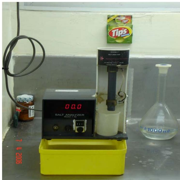
**Foto # 4.** Equipo electrónico Analizador de sal.
