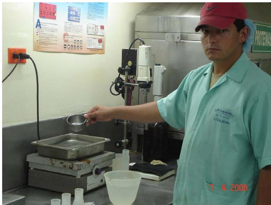
**Foto # 22.** Calentando el agua destilada a una temperatura entre 50° a 60° C.
