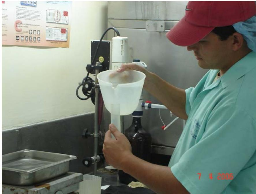
**Foto # 23.** Midiendo 100 ml de agua destilada caliente en la probeta.
