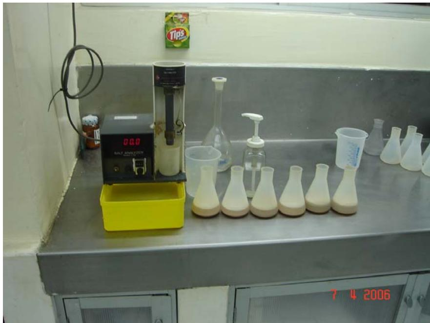
**Foto # 26.** Muestra ya filtrada, en reposo hasta que enfríe.
