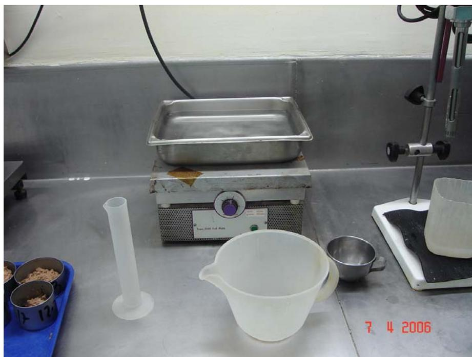
Foto # 8. Reverbero eléctrico usado para calentar agua destilada.
