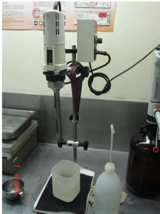
**Foto # 6.** Equipo homogenizador para uso en recipientes de laboratorio de boca angosta.
