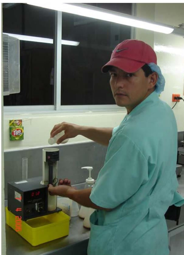
**Foto # 27.** Lectura de la salinidad en el salinómetro.
