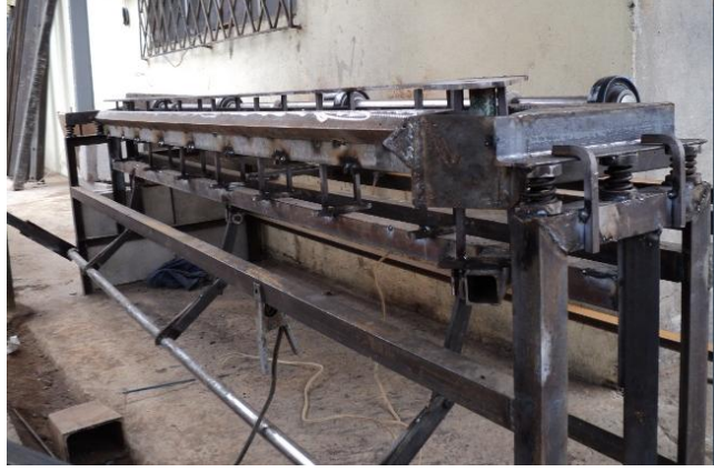
Fotografía 4.3 Funcionamiento del sistema mecánico de evacuación del poste.
