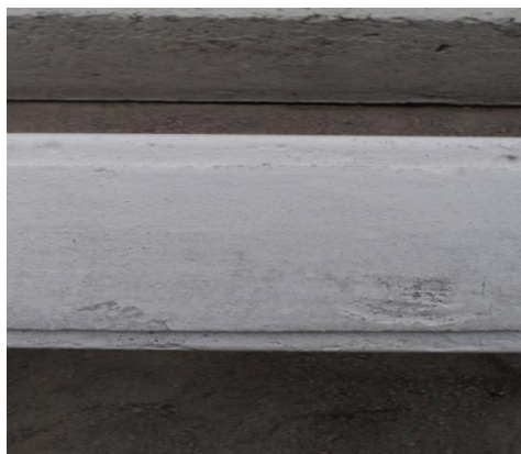
Fotografía 5.5 Poste antes de realizarle la prueba de resistencia mecánica
