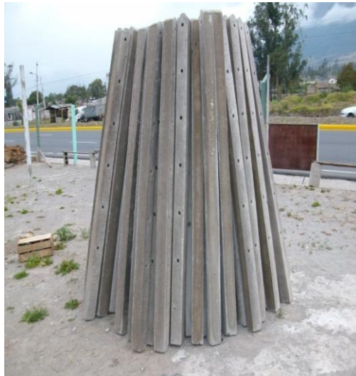
Fotografía 1.19 Secado y almacenamiento de los postes
