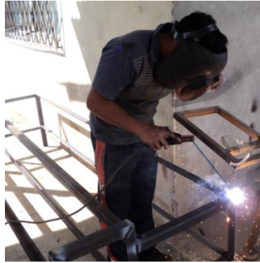
Fotografía 2.8 Proceso de armado de la estructura mediante soldadura eléctrica Fuente: Autor
