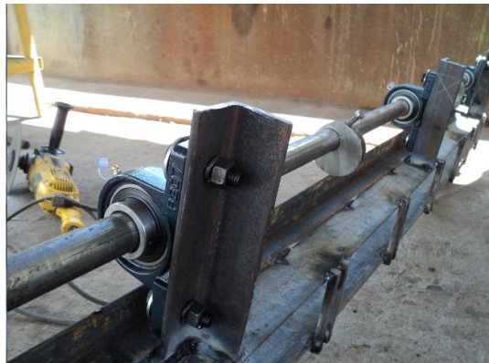
Fotografía 3.4 Construcción inicial del molde con su respectivo sistema mecánico de vibración
