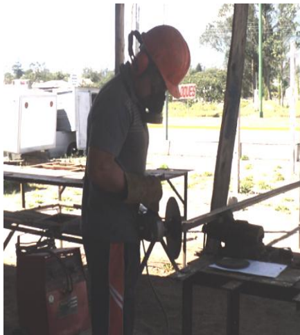
Fotografía 2.4 Proceso de medición y corte
