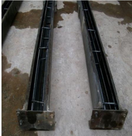
Fotografía 1.10 Molde de acero para fabricar postes de hormigón armado para alambrado perimetral.
