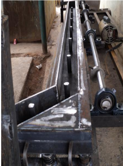
Fotografía 3.5 Construcción final del molde con su respectivo sistema mecánico de vibración Fuente: Autor
