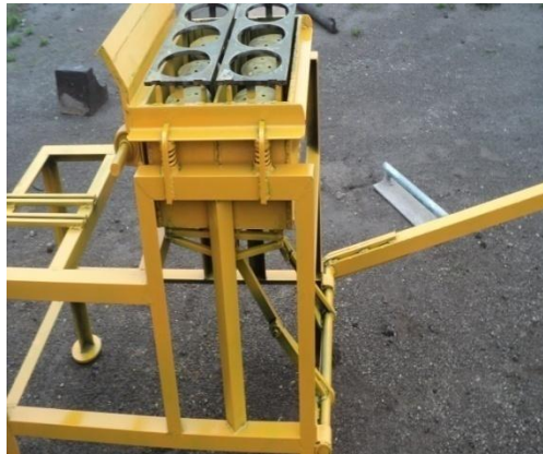
Fotografía 1.6 Sistema de evacuación del prefabricado
