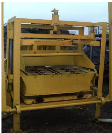
Fotografía 2.2 Estructura de la máquina de bloque vibro prensado
