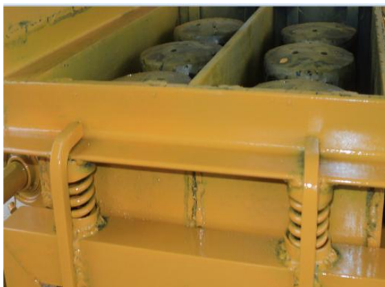
Fotografía 3.3 Resortes utilizados en la maquinaria para prefabricados
