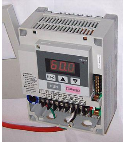
Figura 3.7. Variador de frecuencia.
