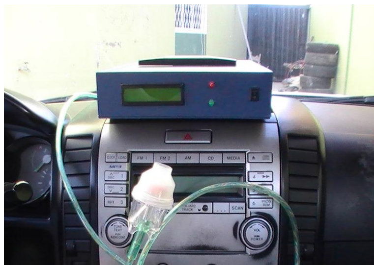
Figura 35 Montaje Final del Sistema Fuente: Autor
