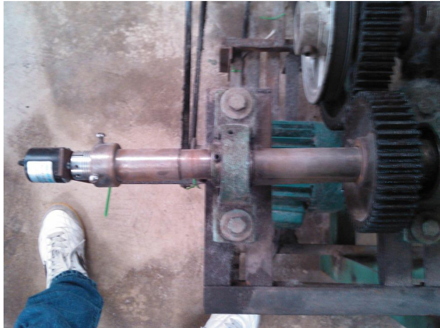
Figura 74. Acople de encoder a la máquina
