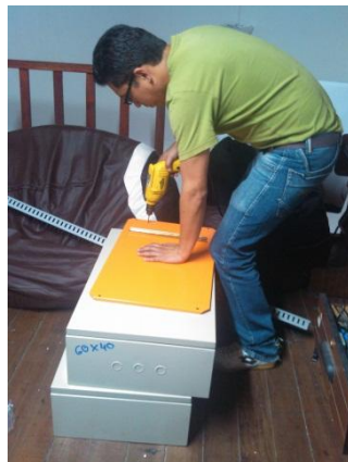
b) Ensamblaje del Tablero de Control
