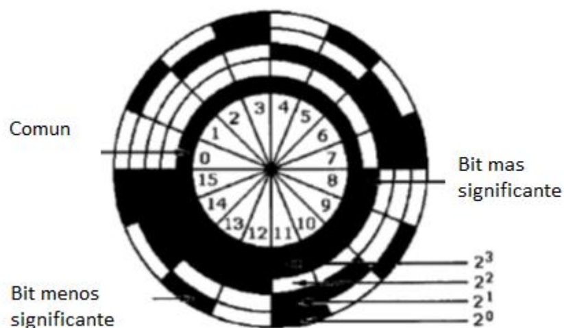
Figura 33. Código Binario del disco de un encoder absoluto
