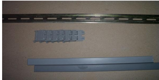
a) Accesorios para la construcción del tablero de control
