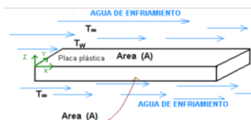
Figura 13 Paleta de plástico donde la cara en la coordenada Z es la que mas emite calor, debido a que hay mayor área
